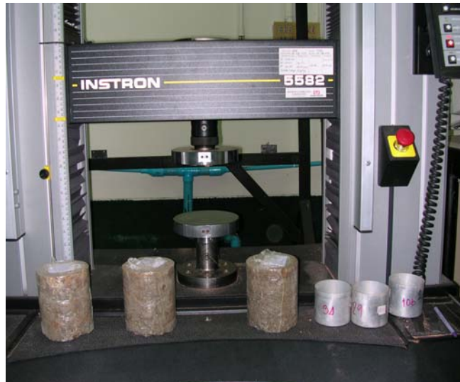
รูปที่ 3.20 เครื่องทดสอบ Universal Testing Machine (UTM)
