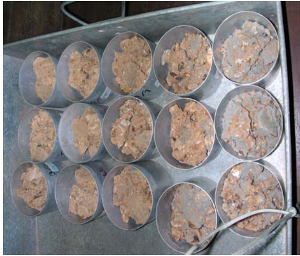
รูปที่ 3.18 การเก็บตัวอย่างหาความชื้นของดินซีเมนต์
