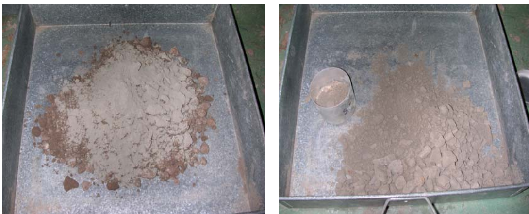
รูปที่ 3.17 ลักษณะการผสมดินกับซีเมนต์
