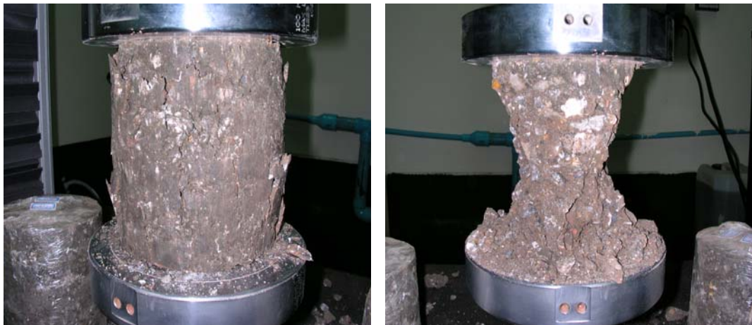
รูปที่ 3.21 ลักษณะการวิบัติของดินซีเมนต์
