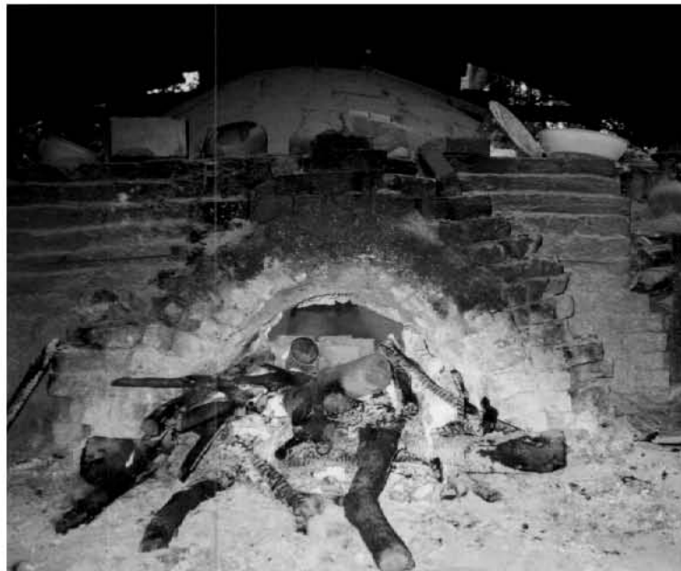
ภาพที่ ๓3 แสดงเตาพื้นแบบค่านเกวียนขณะที่กำลังเผาผลิตภัณฑ์
