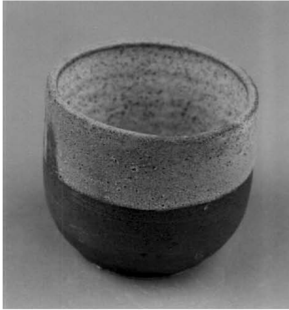
ภาพที่ 67 ถ้วยเนื้อดินปั้นแบบ 3 components เคลือบด้วยสูตรที่ 5/44 ( ชี้ถ้ำไม้ยูคาฯ 20% : Spar glaze 10% : Kaolin-R 70% )เผาที่อุณหภูมิประมาณ 1200 °C ในเตาไม้ฟืนแบบค่านเกวียน
