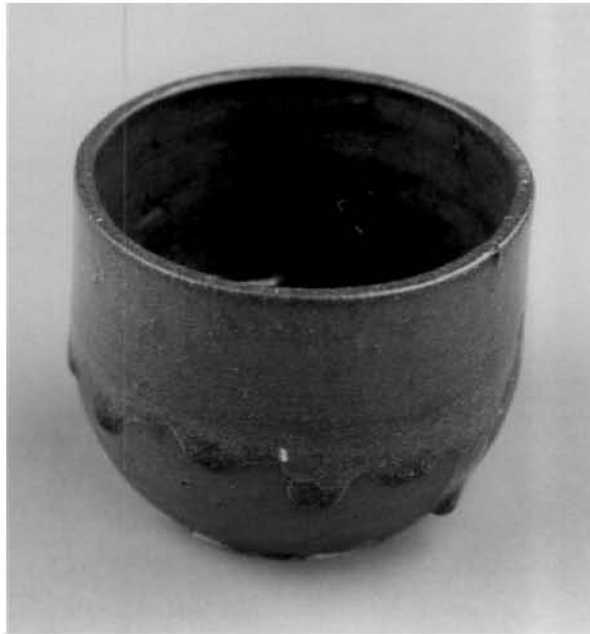
ภาพที่ 45 ถ้วยเนื้อดินปั้นแบบ 2 components เคลือบด้วยสูตรที่ 1/53 ( จี้อ้าไม้ยูคาฯ 10% : Super Spar 10% : Barium Carbonate 10% : Kaolin-R 35% : Milled sand 35% )เผาที่อุณหภูมิประมาณ 1200 °C ในเตาไม้ฟืนแบบค่านเกวียน
