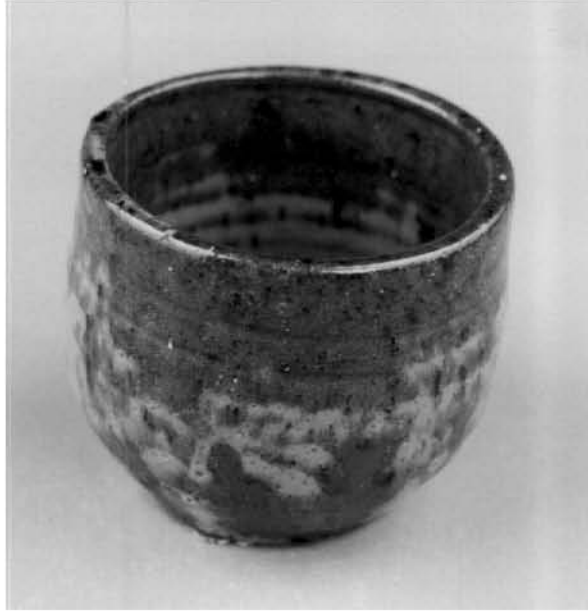
ภาพที่ 63 ถ้วยเนื้อดินปั้นแบบ 3 components เคลือบด้วยสูตรที่ 4/18 ( จี้อัด้าไม้ยูคาฯ 30% : Dolomite 20% : Boric acid 50% ) เผาที่อุณหภูมิประมาณ 1200 °C ในเตาไม้พื้นแบบค่านเกวียน
