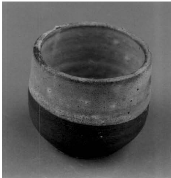
ภาพที่ 68 ถ้วยเนื้อดินปั้นแบบ 3 components เคลือบด้วยสูตรที่ 5/58 (Spar glaze 80% : Kaolin-R 20% )เผาที่อุณหภูมิประมาณ 1200 °C ในเตาไม้ฟืนแบบค่านเกวียน
