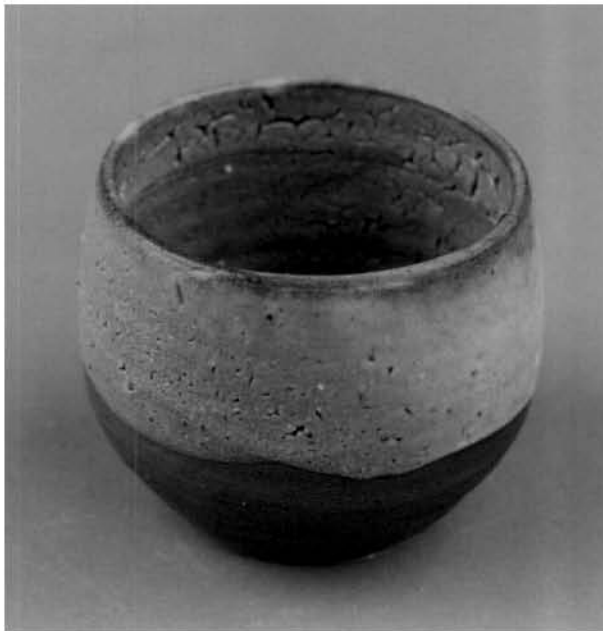
ภาพที่ 50 ถ้วยเนื้อดินปั้นแบบ 3 components เคลือบด้วยสูตรที่ 1/50 ( ชี้อัดไม้ยูคาฯ 10% : Super Spar 25% : Barium Carbonate 25% : Kaolin-R 20% : Milled sand 20% ) เผาที่อุณหภูมิประมาณ 1200 °C ในเตาไม้ฟืนแบบค่านเกวียน
