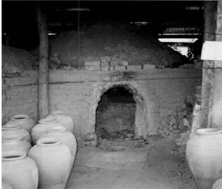
ภาพที่ ๓2 แสดงเตาพื้นแบบค่านเกวียนขณะที่ยังไม่เผาผลิตภัณฑ์
