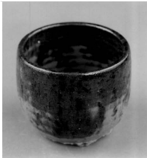
ภาพที่ 62 ถ้วยเนื้อดินปั้นแบบ 2 components เคลือบด้วยสูตรที่ 4/18 ( จี้อ่าไม้ยูคาฯ 30% : Dolomite 20% : Boric acid 50% ) เผาที่อุณหภูมิประมาณ 1200 °C ในเตาไม้ฟืน แบบค่านเกวียน
