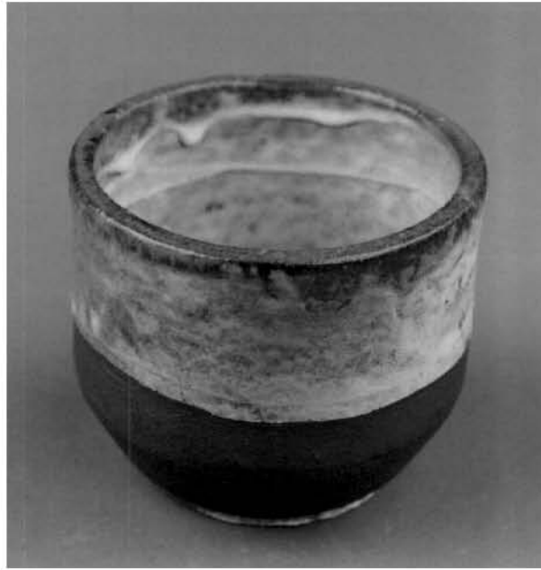
ภาพที่ 59 ถ้วยเนื้อดินปั้นแบบ 2 components เคลือบด้วยสูตรที่ 3/56 (Spar glaze 100%) เผาที่อุณหภูมิประมาณ 1200 °C ในเตาไม้ฟืนแบบค่านเกวียน
