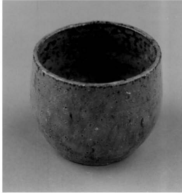
ภาพที่ 51 ถ้วยเนื้อดินปั้นแบบ 2 components เคลือบด้วยสูตรที่ 2/35 ( ซี้เจ้าไม้ยูคาฯ 30% :Super Spar 10%: Boric acid 60% ) เผาที่อุณหภูมิประมาณ 1200 °C ในเตาไม้พินแบบค่านเกวียน
