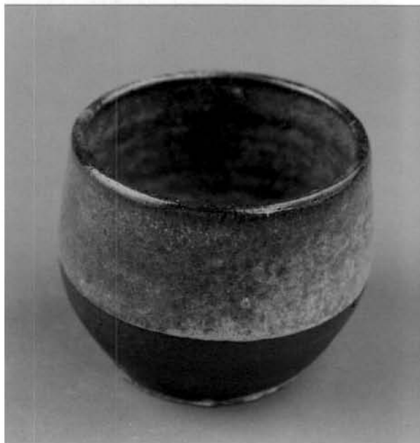
ภาพที่ 66 ถ้วยเนื้อดินปั้นแบบ 2 components เคลือบด้วยสูตรที่ 5/24 ( ชี้เถ้าไม้ยูคาฯ 40% : Spar glaze 40% : Kaolin-R 20% ) เผาที่อุณหภูมิประมาณ 1200 °C ในเตาไม้ฟืน แบบค่านเกวียน
