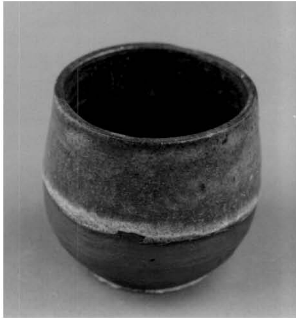
ภาพที่ 47 ถ้วยเนื้อดินปั้นแบบ 3 components เคลือบด้วยสูตรที่ 1/24 ( ژیเต้าไม้ยูคาฯ 40% : Super Spar 20% : Barium Carbonate 20% : Kaolin-R 10% : Milled sand 10% ) เผาที่อุณหภูมิประมาณ 1200 °C ในเตาไม้พื้นแบบค่านเกวียน
