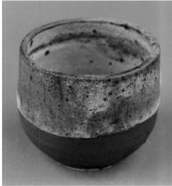
ภาพที่ 61 ถ้วยเนื้อดินปั้นแบบ 3 components เคลือบด้วยสูตรที่ 3/26 ( จี้อ่าไม้ยูคาฯ 40% : Spar glaze 20% :Talcum 40% ) เผาที่อุณหภูมิประมาณ 1200 °C ในเตาไม้ฟืน แบบค่านเกวียน
