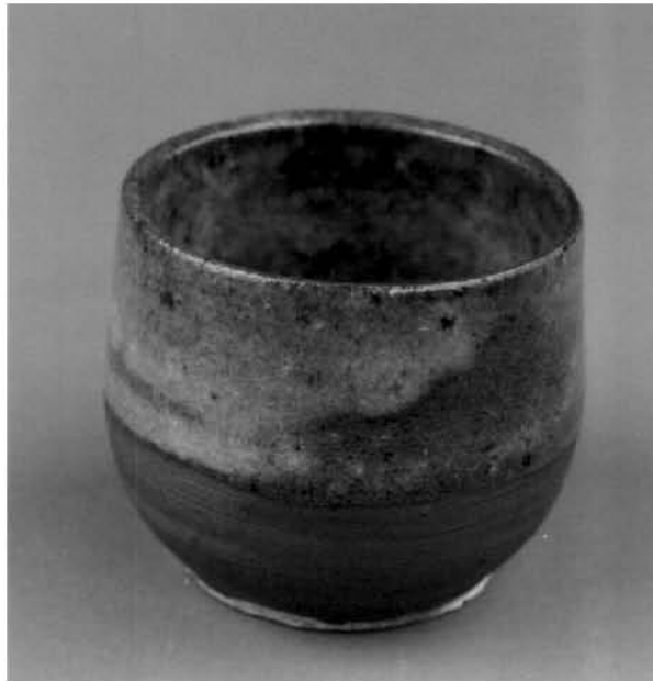
ภาพที่ 60 ถ้วยเนื้อดินปั้นแบบ 3 components เคลือบด้วยสูตรที่ 3/16 ( ไม้ซุงคาก 50% : Spar glaze 50% ) เผาที่อุณหภูมิประมาณ 1200 °C ในเตาไม้ฟืนแบบค่านเกวียน
