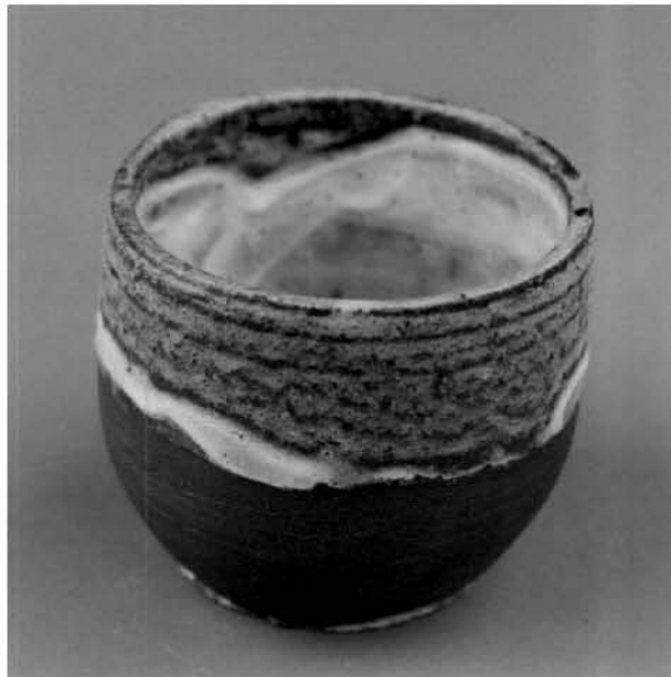
ภาพที่ 57 ถ้วยเนื้อดินปั้นแบบ 2 components เคลือบด้วยสูตรที่ 3/37 ( ژی๊ด้าไม้ยูคาฯ 20% : Spar glaze 80% ) เผาที่อุณหภูมิประมาณ 1200 °C ในเตาไม้ฟืนแบบค่านเกวียน
