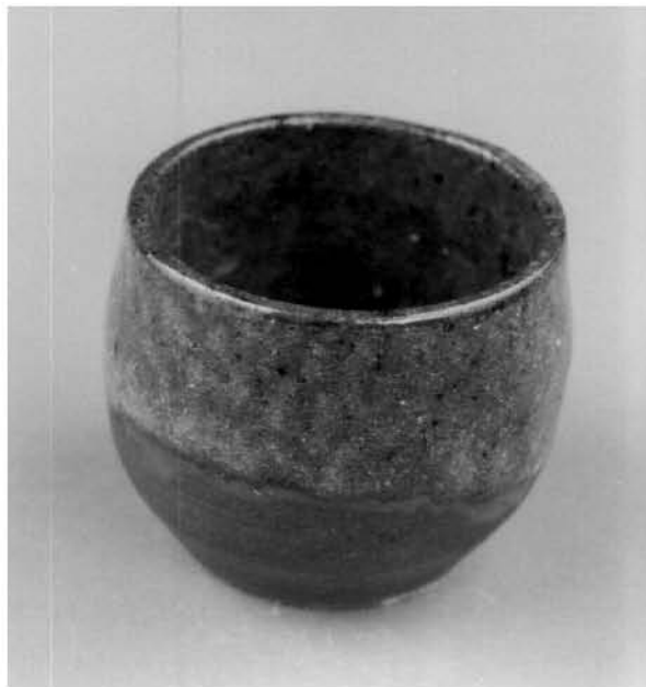
ภาพที่ 64 ถ้วยเนื้อดินปั้นแบบ 3 components เคลือบด้วยสูตรที่ 4/30 ( จี้อัด้าไม้ยูคาฯ 10% : Dolomite 40% : Boric acid 50% ) เผาที่อุณหภูมิประมาณ 1200 °C ในเตาไม้พื้นแบบค่านเกวียน
