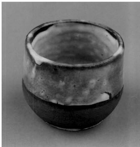
ภาพที่ 46 ถ้วยเนื้อดินปั้นแบบ 2 components เคลือบด้วยสูตรที่ 1/58 (Super Spar 40% : Barium Carbonate 40% : Kaolin-R 10% : Milled sand 10% ) เผาที่อุณหภูมิประมาณ 1200 °C ในเตาไม้ฟืนแบบค่านเกวียน
