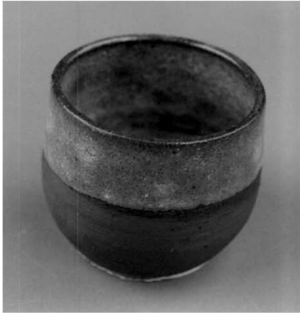
ภาพที่ 65 ถ้วยเนื้อดินปั้นแบบ 2 components เคลือบด้วยสูตรที่ 5/23 ( ชี้เถ้าไม้ยูคาฯ 40% : Spar glaze 50% : Kaolin-R 10% ) เผาที่อุณหภูมิประมาณ 1200 °C ในเตาไม้ฟืน แบบค่านเกวียน
