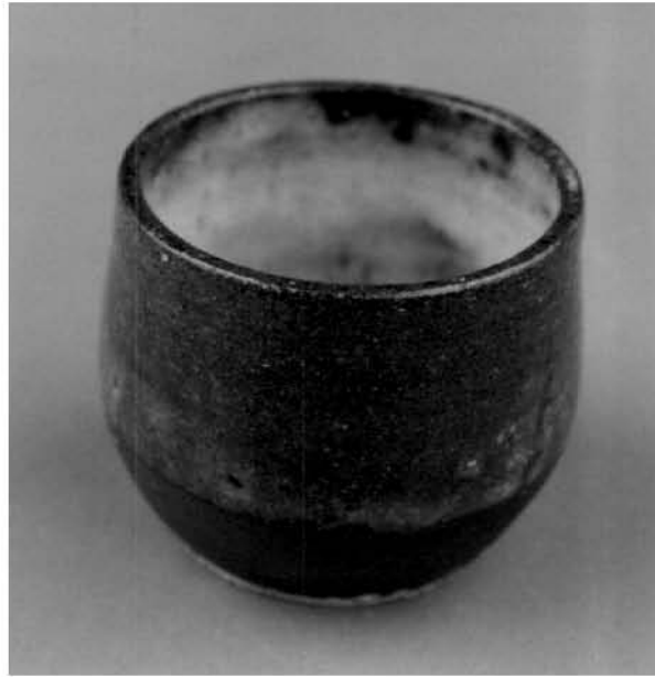
ภาพที่ 53 ถ้วยเนื้อดินปั้นแบบ 2 components เคลือบด้วยสูตรที่ 2/40 ( ซี้เจ้าไม้ยูคาฯ 20% : Super Spar 50% : Boric acid 30% ) เผาที่อุณหภูมิประมาณ 1200 °C ในเตาไม้พินแบบด้านเกวียน
