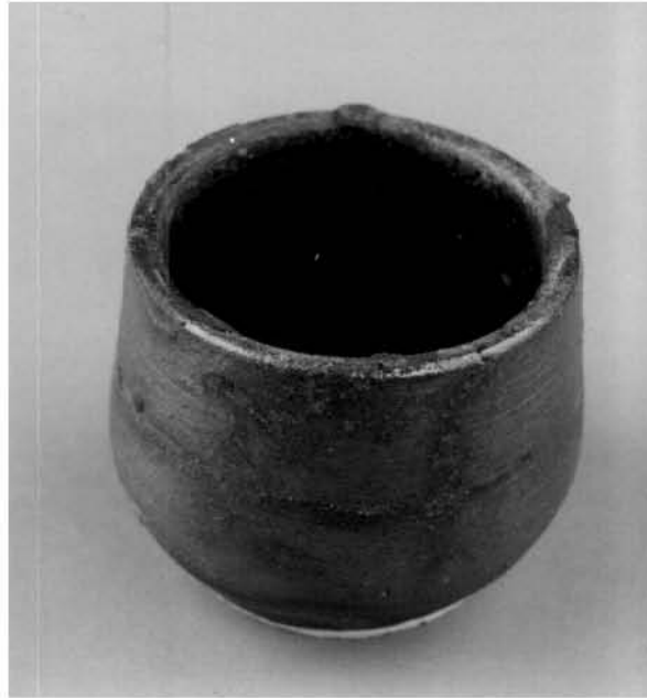
ภาพที่ 41 ถ้วยเนื้อดินปั้นแบบ 2 components เคลือบด้วยสูตรที่ 1/2 ( ซึ่ถ้าไม่ยูคาฯ 90% : Super Spar 5% :Barium Carbonate 5% ) เผาที่อุณหภูมิประมาณ 1200 °C ในเตาไม้พินแบบดำนเกวียน
