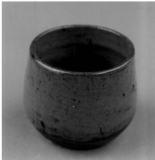
ภาพที่ 54 ถ้วยเนื้อดินปั้นแบบ 2 components เคลือบด้วยสูตรที่ 2/63 ( Super Spar 30% : Boric acid 70% ) เผาที่อุณหภูมิประมาณ 1200 °C ในเตาไม้พินแบบด้านเกวียน
