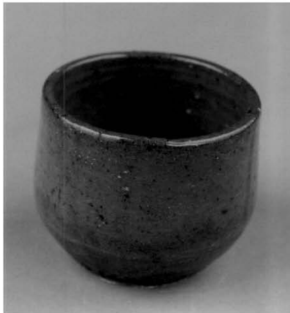
ภาพที่ 56 ถ้วยเนื้อดินปั้นแบบ 3 components เคลือบด้วยสูตรที่ 2/63 (Super Spar 30% : Boric acid 70% ) เผาที่อุณหภูมิประมาณ 1200 °C ในเตาไม้ฟืนแบบค่านเกวียน
