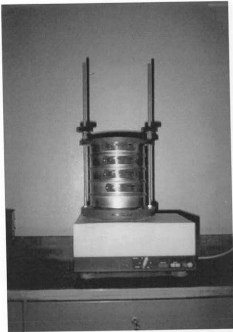
รูปที่ 3.3 ชุดตะแกรงร่อนพร้อมเครื่องเขย่า (Sieves and Sieve shaker)
