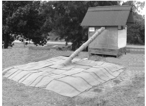
รูปที่ 8 แบบจำลองทางกายภาพ ประกอบด้วยบ่อกักเก็บพลังงาน และบ้านจำลองย่อยส่วน โดยมีท่ออากาศร้อนขนาด 4 นิ้วต่ออยู่
