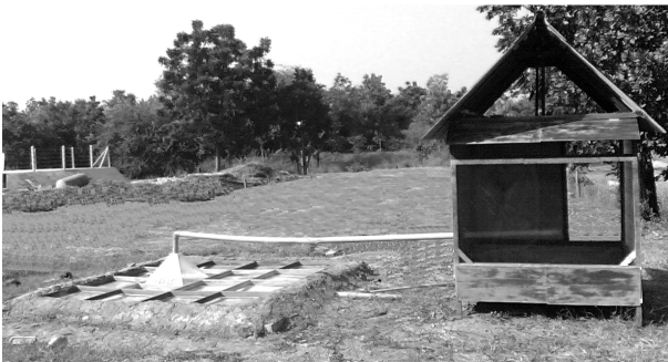
รูปที่ 6 แบบจำลองทางกายภาพ ประกอบด้วยบ่อกักเก็บพลังงาน (ซ้าย) และบ้านจำลอง (ขวา) โดยมีท่ออากาศร้อนขนาด 2 นิ้วต่ออยู่
