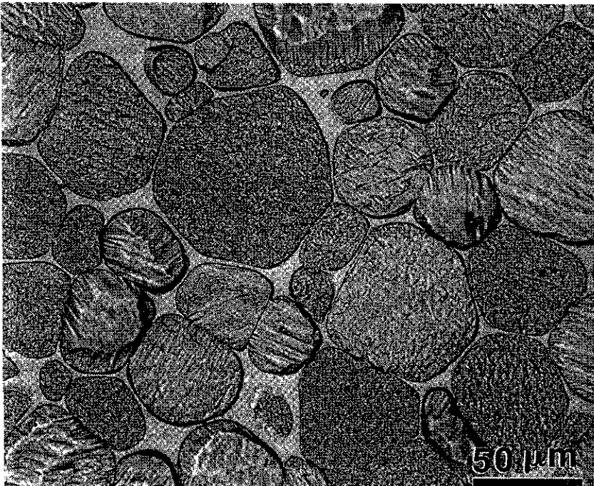
รูปที่ 2.5 ตัวอย่างโครงสร้างจุลภาคของชิ้นงาน W-3.5Ni-1.5Fe เผาผนึกที่ 1470 องศาเซลเซียสเป็นเวลา 2 ชั่วโมงภายใต้บรรยากาศไฮโดรเจน (German, 1996)
