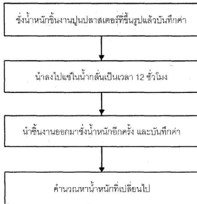
รูปที่ 3.11 วิธีการทดสอบอัตราการดูดซึมน้ำของปูนปลาสเตอร์
