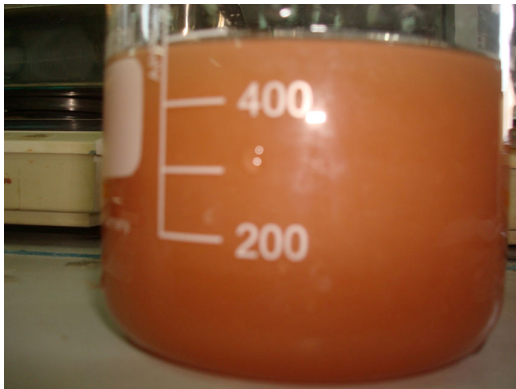
ภาพที่ 13 ปริมาณตะกอนหลังการทดสอบโดยผสม CaO 0 เปอร์เซ็นต์: จะ เห็นได้ว่าน้ำตะกอนมีความขุ่นมาก
