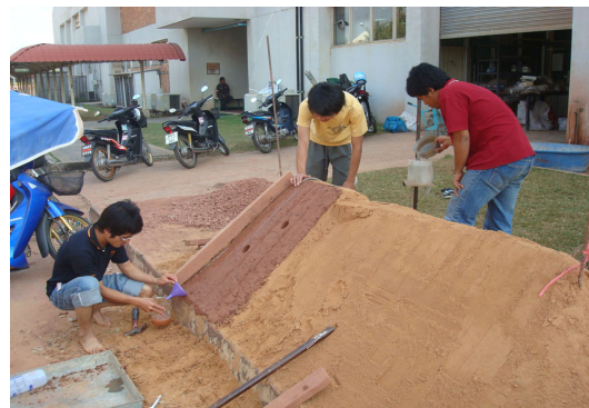
ภาพที่ 11 แปลงทดสอบการปรับปรุงดินเหนียวกระจายตัวด้วยปูนขาว ที่ความชัน 1:1
