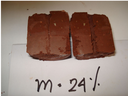
ภาพที่ 6 การผ่าตัวอย่างออกเพื่อตรวจสอบขนาดของรูเจาะ
