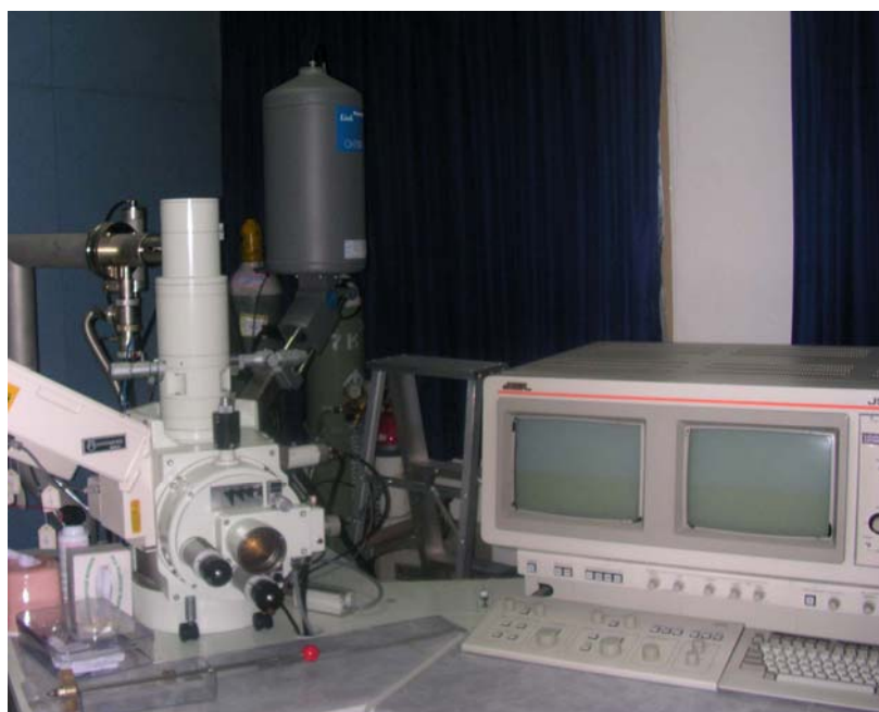
รูปที่ 3.3 กล้องจุลทรรศน์ชนิดส่องกราด (Scanning Electron Microscope)
