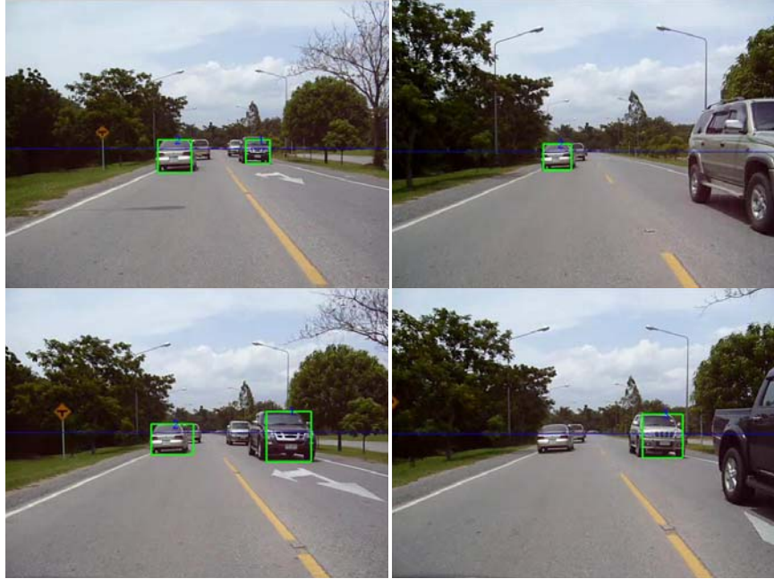
รูปที่ 5.54 ตัวอย่างผลการติดตามพาหนะภาพวิดีโอที่ 4
