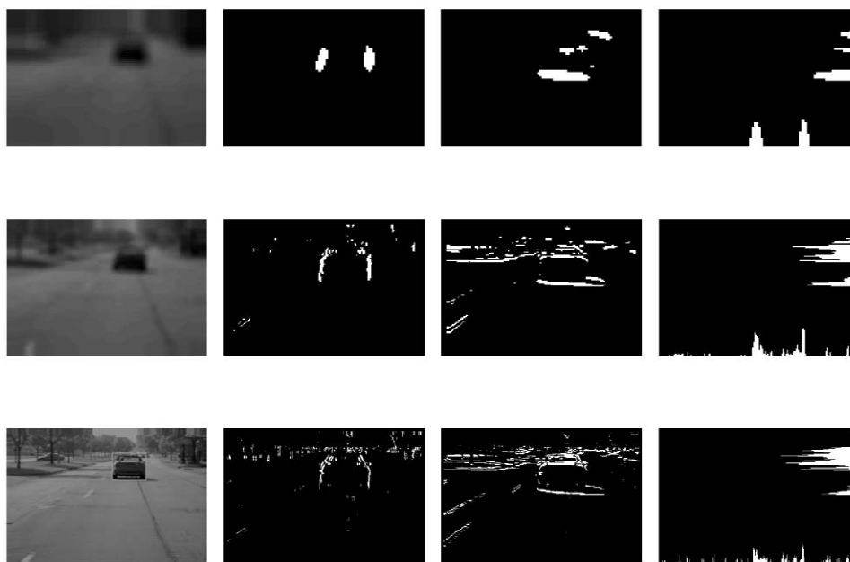
รูปที่ 2.9 กระบวนการตรวจหาพหุแบบหลายสเกลจากขอบแนวตั้งและขอบแนวนอน โดยที่แถวที่ 1 ขนาด 90x62 แถวที่ 2 ขนาด 180x124 และแถวที่ 3 ขนาด 360x248
