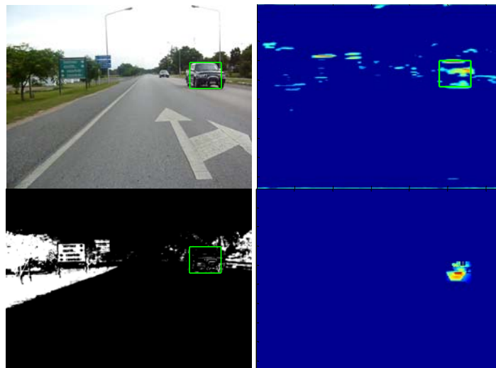
รูปที่ 5.13 ตัวอย่างผลการตรวจหาพาหนะภาพวิดีโอชุดที่ 5 จากภาพซ้ายไปขวาและบนลงล่างแสดง ผลการตรวจหาพาหนะ ขนาดของกาบอร์ ภาวะระดับ S และค่าพลังงานพาหนะตามลำดับ
