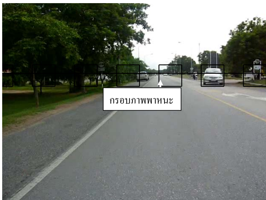
รูปที่ 3.4 กรอบภาพพาหนะที่ตำแหน่งจุดภาพขอล่างของกรอบภาพพาหนะเท่ากัน
