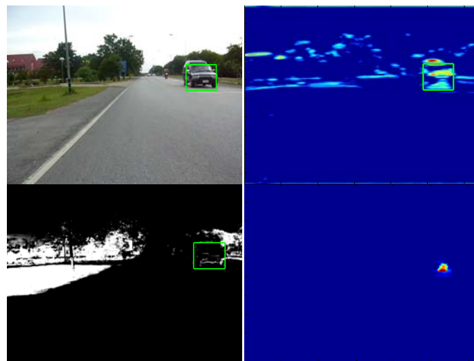
รูปที่ 5.3 ตัวอย่างผลการตรวจหาพาหนะภาพวิดีโอที่ 1 จากภาพซ้ายไปขวาและบนลงล่างแสดง ผลการตรวจหาพาหนะ ขนาดของกาบอร์ ภาพระดับ S และค่าพลังงานพาหนะตามลำดับ
