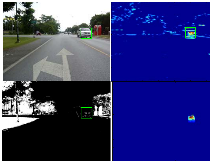
รูปที่ 5.20 ตัวอย่างผลการตรวจหาพาหนะภาพวีดิทัศน์ชุดที่ 6 จากภาพซ้ายไปขวาและบนลงล่างแสดง ผลการตรวจหาพาหนะ ขนาดของกาบอร์ ภาพระดับ S และค่าพลังงานพาหนะตามลำดับ
