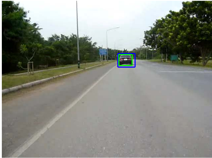
รูปที่ 3.36 ผลจากการตัดกรอบภาพพาหนะตามแนวตั้งและแนวนอน
