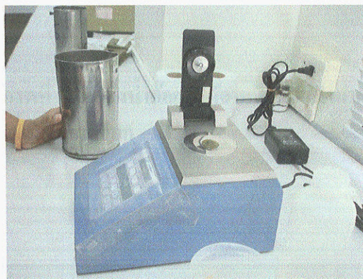
ภาพที่ 22 แสดงเครื่อง Refractometer ดิจิตอล 2 ตำแหน่ง ยี่ห้อ Bellingham+Stanley Ltd. รุ่น RFM 340
