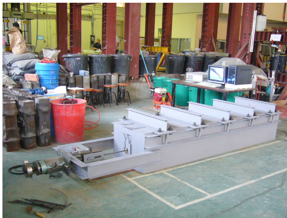
รูปที่ 3.3 อุปกรณ์ทดสอบแรงกดของเหล็กเสริมแบกทาน
