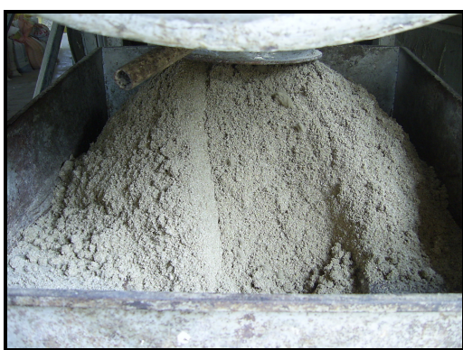
ภาพที่ ก.1 แสดงส่วนประกอบต่าง ๆ ที่ผสมเข้ากันดีแล้วเตรียมเข้าเครื่องอัดเม็ด
