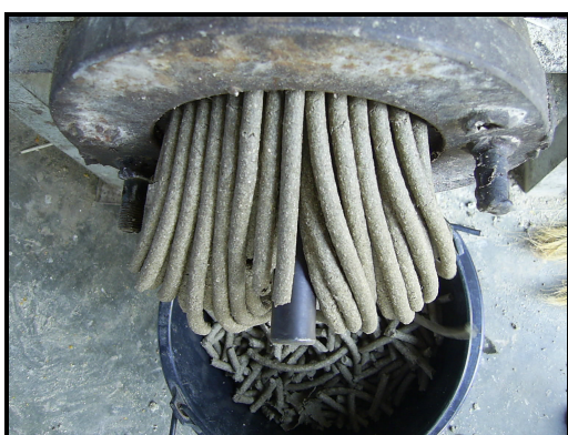
ภาพที่ ก.3 แสดงเม็ดที่ออกมาด้วยเครื่องอัดเม็ด
