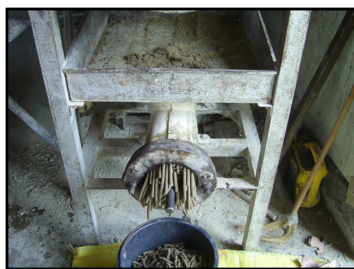
ภาพที่ ก.2 แสดงการอัดเม็ดด้วยเครื่องอัดเม็ด
