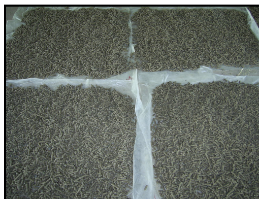
ภาพที่ ก.4 แสดงการตาก Casleurea ที่อัดเม็ดด้วยเครื่องอัดเม็ด
