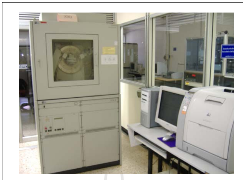
รูปที่ 3.3 เครื่องทดสอบองค์ประกอบทางเคมี X-Ray Diffractometer Analysis (XRD)
