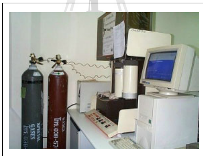
รูปที่ 3.1 หาพื้นที่ผิวจำเพาะ BET Surface Area Analyzer
