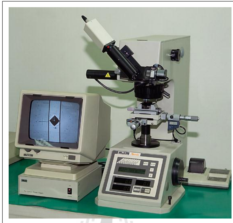
รูปที่ 2.18 แสดงเครื่องทดสอบความแข็งระดับจุลภาคจากกล้องจุลทรรศน์จะแสดงบนจอภาพ ที่แยกออกมาจากเครื่อง สามารถวัดความยาวเส้นทแยงมุมของรอยกดได้บนจอภาพ
