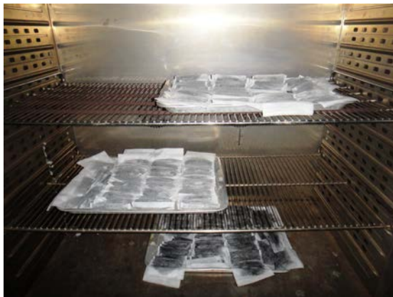
รูปที่ 3.8 อบแห้งแบบชั้นบางที่ 105^{\circ}\text{C} 2 ชั่วโมง เป็นครั้งที่ 2
