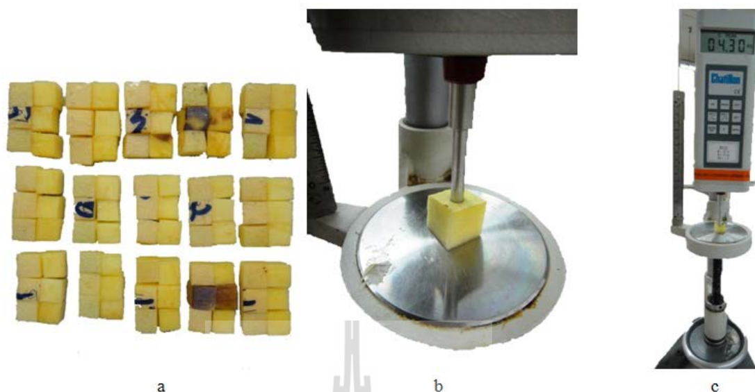
รูปที่ 3.2 a: ชิ้นตัวอย่างมีเปลือกและเนื้อตำแหน่งบน กลาง และล่างของผลจำนวน 15 ผล b: การกด penetrometer c: การแสดงค่าของเครื่อง
