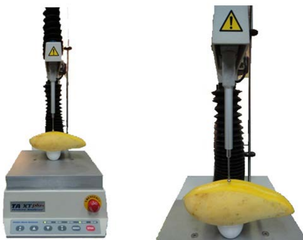
รูปที่ 3.13 การใช้ texture analyzer และตำแหน่งกด
