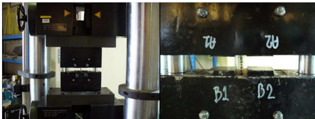
รูปที่ ก.21 การติดตั้งตัวอย่างสำหรับการทดสอบแรงอัดตามแนวแกนของเส้นใย
