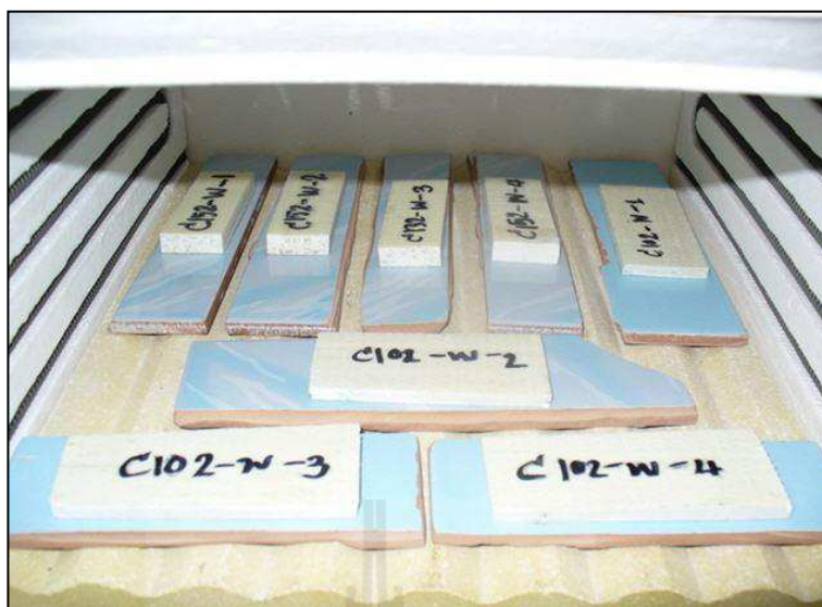
รูปที่ ก.10 ลักษณะตัวอย่างที่ถูกเผาด้วยอุณหภูมิ 565°C
