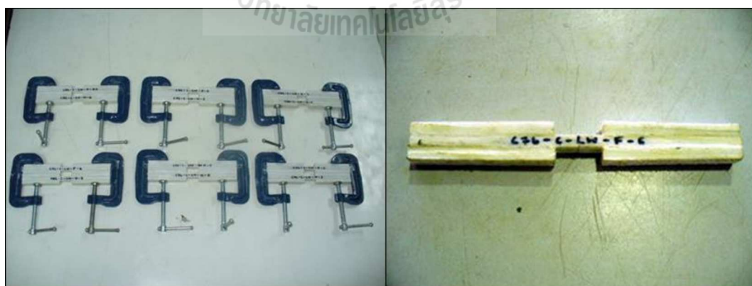
รูปที่ ก.18 ลักษณะตัวอย่างทดสอบสำหรับการทดสอบแรงอัดตามแนวแกนของเส้นใย
