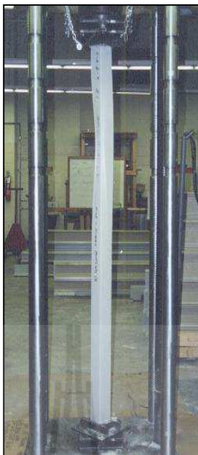
รูปที่ 2.13 การโค้งเดาะแบบเฉพาะที่ของเสาผนังบาง (Seangatith, 2000)
