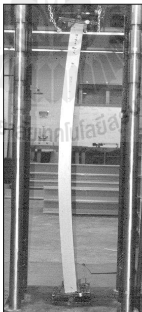
รูปที่ 2.12 การโก่งเดาะแบบการค้ำของเสาผนังบาง (Seangathith, 2000)
