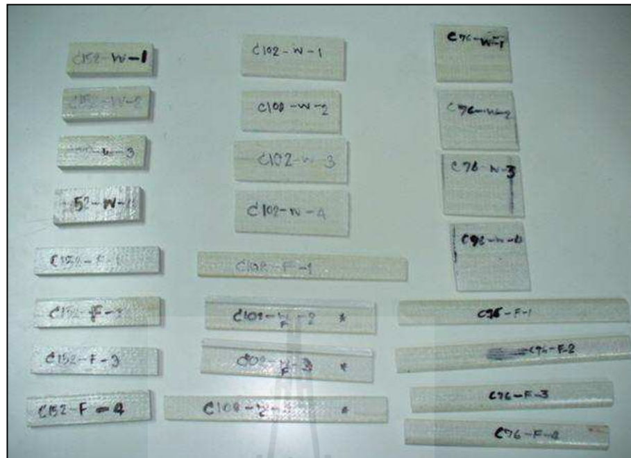
รูปที่ ก.4 ลักษณะตัวอย่างสำหรับการทดสอบความหนาแน่นและความถ่วงจำเพาะ
