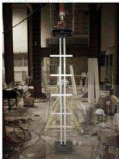
รูปที่ 4 การติดตั้งตัวอย่างทดสอบ PFRP หน้าตัดรูป วงรีภายใต้แรงอัดในแนวแกน
