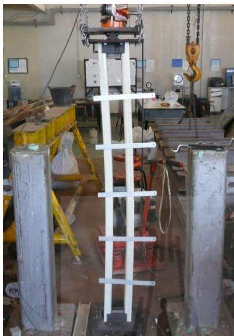
รูปที่ 4.18 ลักษณะการวิบัติของตัวอย่างที่มีการติดจุดเชื่อมต่อเพิ่มที่ระยะกึ่งกลางความยาว
