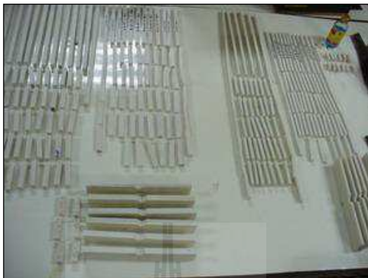
รูปที่ ก.13 ลักษณะตัวอย่างทดสอบสำหรับการทดสอบคุณสมบัติทางกล
