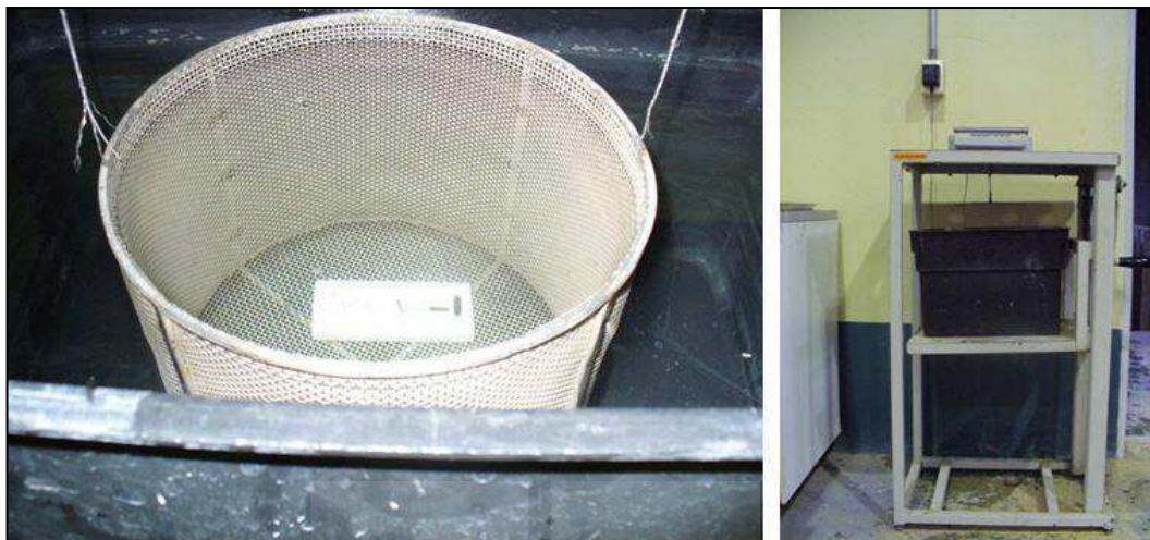
รูปที่ ก.6 การชั่งน้ำหนักตัวอย่างทดสอบในน้ำ
