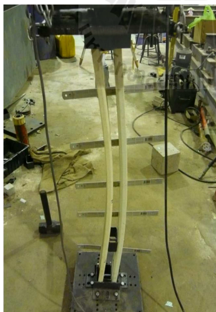
รูปที่ 4.32 ลักษณะการวิบัติแบบ individual parallel buckling ของตัวอย่างทดสอบที่มีการติดจุดเชื่อมต่อเพิ่มที่ระยะ L/4
