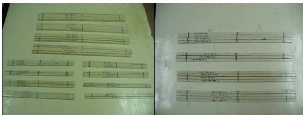
รูปที่ ก.28 ลักษณะตัวอย่างทดสอบสำหรับการทดสอบแรงดัดตามแนวแกนของเส้นใย
