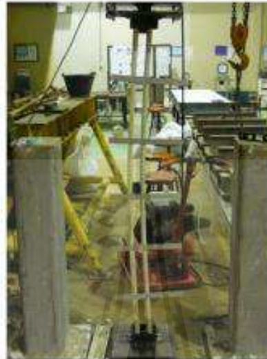
รูปที่ 9 ตัวอย่างลักษณะการวิบัติของตัวอย่างทดสอบยาวแบบ individual parallel buckling
