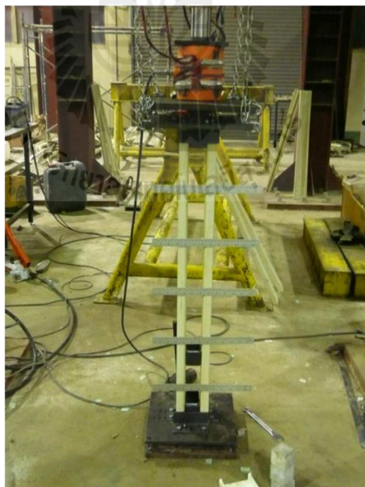
รูปที่ 3.13 การติดตั้งตัวอย่างเสาประกอบ PFRP ที่มีจุดเชื่อมต่อที่ปลายทั้งสองข้างและมีการติดเพิ่มระหว่างปลายทั้งสองข้าง
