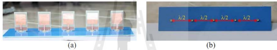
Figure 4: Linear array antennas
