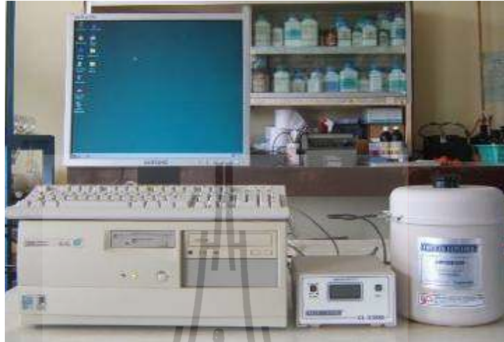
ภาพที่ 3.7 ชุดควบคุมการลดอุณหภูมิในระหว่างกระบวนการเก็บรักษาน้ำเชื้อปลาโดยวิธีการแช่แข็งโดยมี Freezer control (CL 3300) ร่วมกับโปรแกรม Cryogenesis
