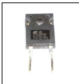
รูปที่ 5.13 ไดโอดที่ใช้ในวงจรแปลงผันแบบชอปเปอร์ทางด้านวงจรสนาม
