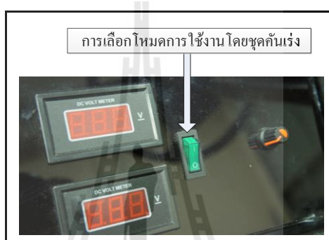
รูปที่ ก.1 สวิตซ์ที่ใช้เลือกโหมดใช้งานคันเร่ง
