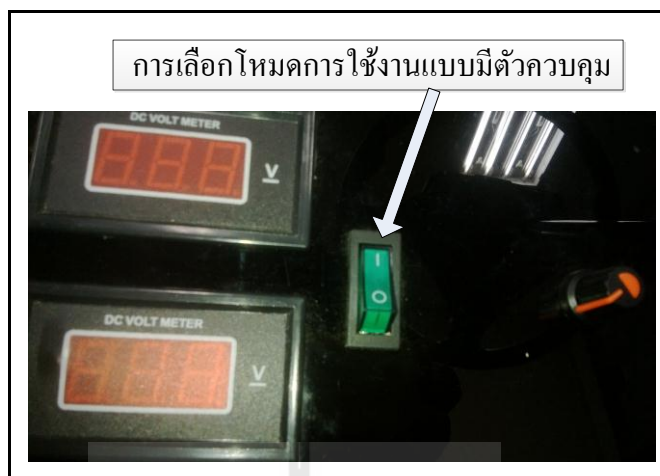
รูปที่ ก.4 สวิตช์ที่ใช้เลือกโหมดการใช้งานแบบมีตัวควบคุม
