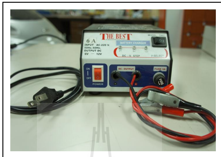
รูปที่ ข.5 อุปกรณ์ชาร์จแบตเตอรี่ทางด้านฟักัดกระแสสูง
