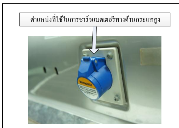
รูปที่ ข.2 ตำแหน่งสำหรับชาร์จแบตเตอรี่ทางด้านพิกัดกระแสสูง
