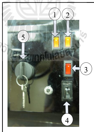
รูปที่ ก.5 ลำดับการกดสวิตซ์ในกรณีใช้งานรถไฟฟ้า
