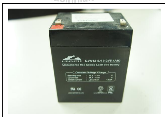
รูปที่ ข.4 แบตเตอรี่ที่ใช้เป็นแหล่งจ่ายของวงจรจุดชนวนเกท
