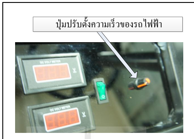
รูปที่ ก.6 ปุ่มปรับตั้งความเร็วของรถไฟฟ้า
