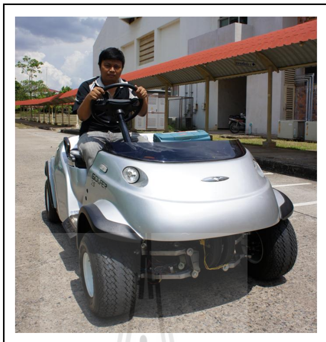
รูปที่ 6.7 การทดสอบระบบขับเคลื่อนรถไฟฟ้าเมื่อไม่มีตัวควบคุม
