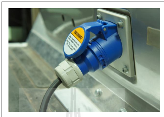
รูปที่ ข.3 ลักษณะการชาร์จแบตเตอรี่ทางด้านพิกัดกระแสสูง
