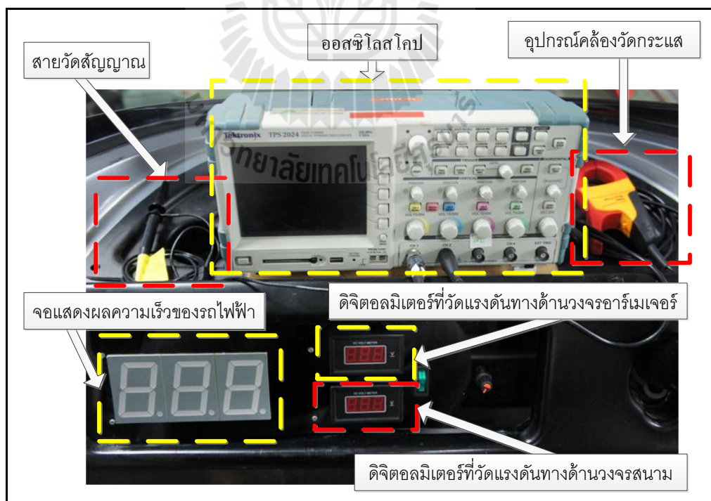
รูปที่ 6.8 เครื่องมือวัดที่ใช้ในการทดสอบระบบขับเคลื่อนรถไฟฟ้าเมื่อไม่มีตัวควบคุม
