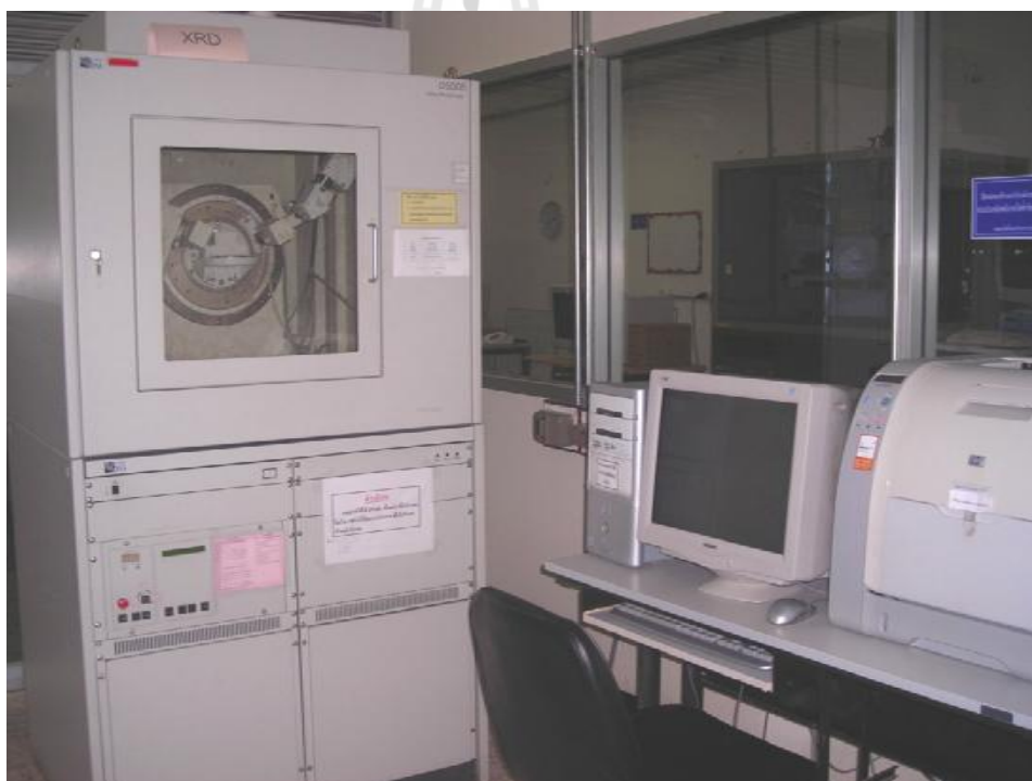
รูปที่ 3.3 เครื่องวิเคราะห์โครงสร้างผลึก (XRD)
