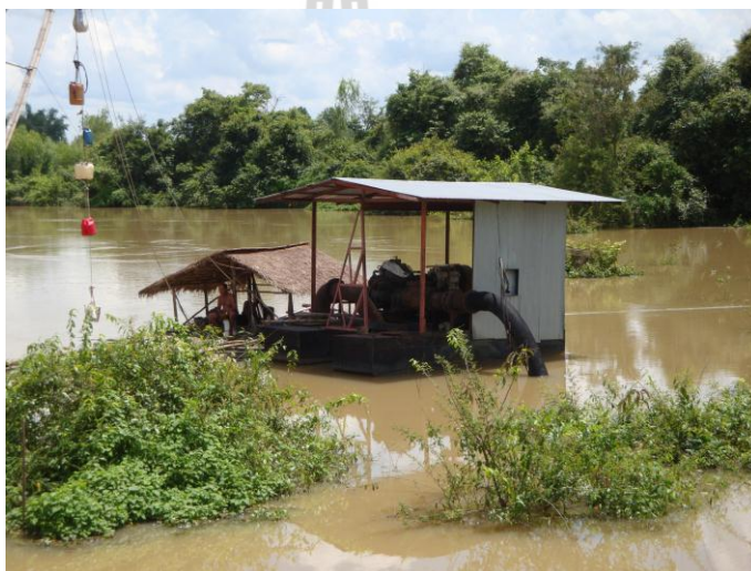
(ข) เครื่องสูบน้ำจากลำน้ำปาวที่เกษตรกรในพื้นที่ใช้สูบน้ำเข้ามาในพื้นที่การเกษตร
