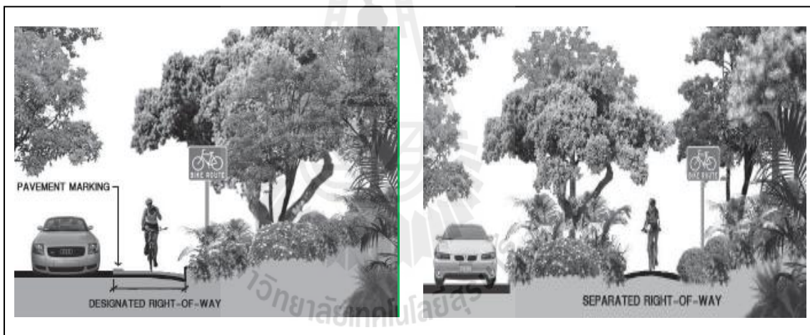
รูปที่ 4.24 ตัวอย่างรูปตัดแสดงการแยกช่องทางสัญจรระหว่างทางรถยนต์ และทางจักรยาน
