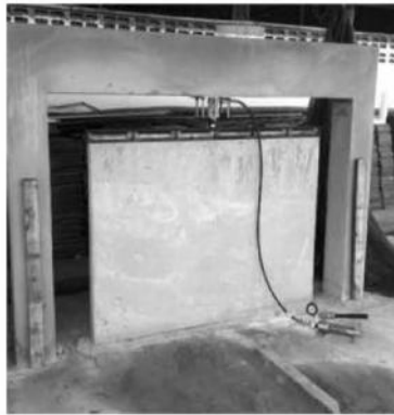
ภาพที่ 6 การทดสอบกำลังอัดของผนังหล่อในที่
