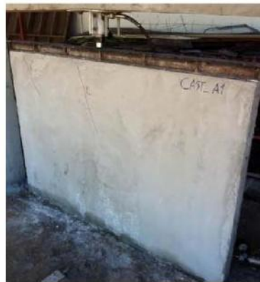
ภาพที่ 7 การทดสอบกำลังอัดของผนังหล่อในที่
