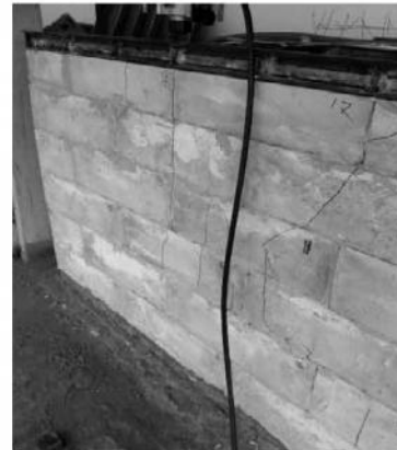
ภาพที่ 8 การทดสอบกำลังอัดของผนังอิฐผลิตเอง
