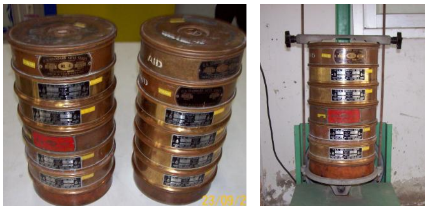
รูปที่ 3.3 การทดสอบการหาขนาดผละของทราย
