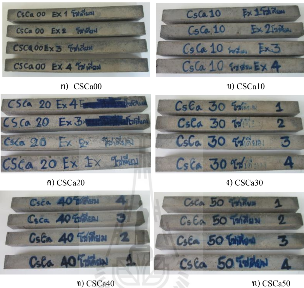
รูปที่ 4.42 ลักษณะแท่งตัวอย่างแช่ในสารละลายโซเดียมซัลเฟต ของมอร์ต้าร์ CSCa อายุการแช่ที่ 112 วัน
