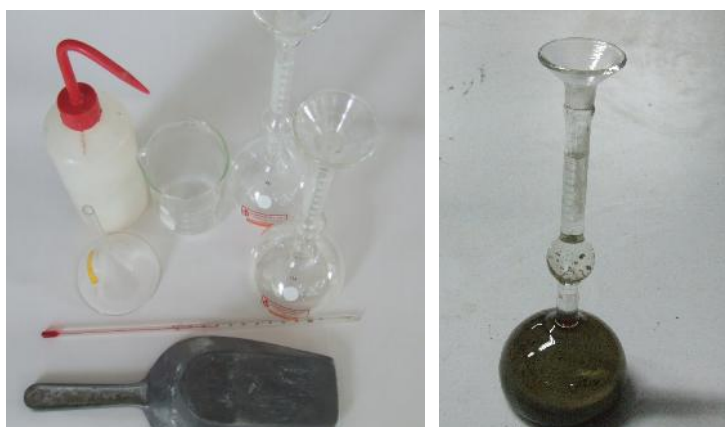
รูปที่ 3.4 การทดสอบหาค่าความถ่วงจำเพาะของปูนซีเมนต์
