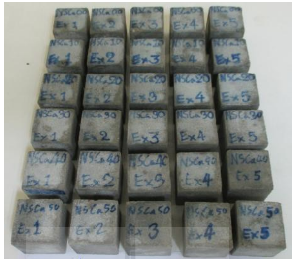
รูปที่ 4.21 ตัวอย่างมอร์ต้าร์ NSCa แข็งในสารละลายโซเดียมซัลเฟตที่อายุ 112 วัน
