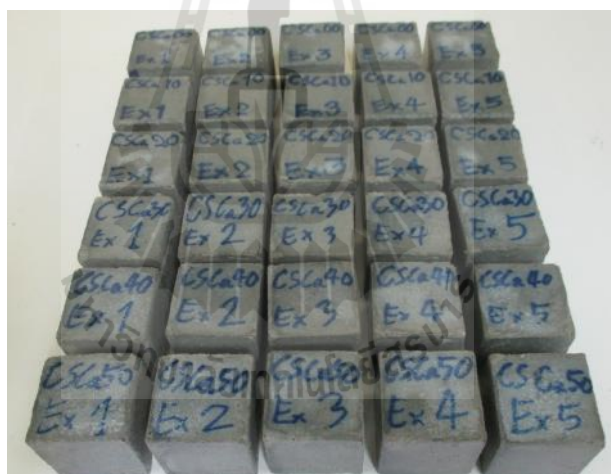
รูปที่ 4.20 ตัวอย่างมอร์ต้าร์ CSCa แช่ในสารละลายโซเดียมซัลเฟตที่อายุ 112 วัน
