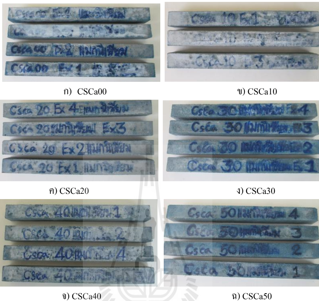
รูปที่ 4.44 ลักษณะแท่งตัวอย่างแช่ในสารละลายแมกนีเซียมซัลเฟต ของมอร์ต้าร์ CSCa อายุการแช่ที่ 112 วัน
