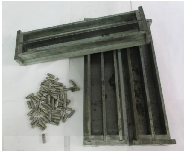
รูปที่ 3.7 ชุดแบบหล่อและเหล็กสตั๊ด สำหรับทดสอบการหดตัวแห้งและการขยายตัวของมอร์ต้าร์
