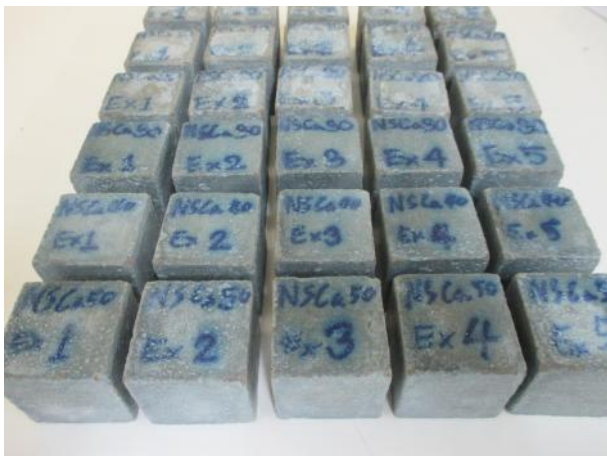
รูปที่ 4.23 ตัวอย่างมอร์ต้าร์ NSCa แข็งในสารละลายแมกนีเซียมซัลเฟตที่อายุ 112 วัน
