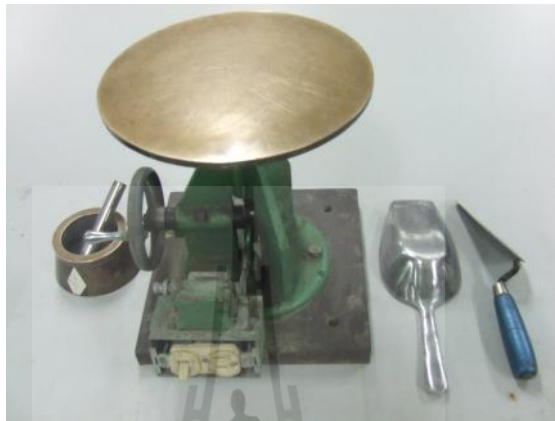
รูปที่ 3.5 ชุดทดสอบหาค่าการไหลแผ่ของมอร์ต้าร์
