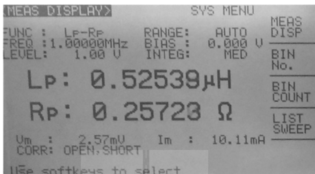
รูปที่ 4.9 ค่าความเหนี่ยวนำสำหรับแมตซิงกับวงจรเมื่อโหลดไดโอดีเล็กตริกมีขนาดความหนาเท่ากับ 10 มิลลิเมตร
