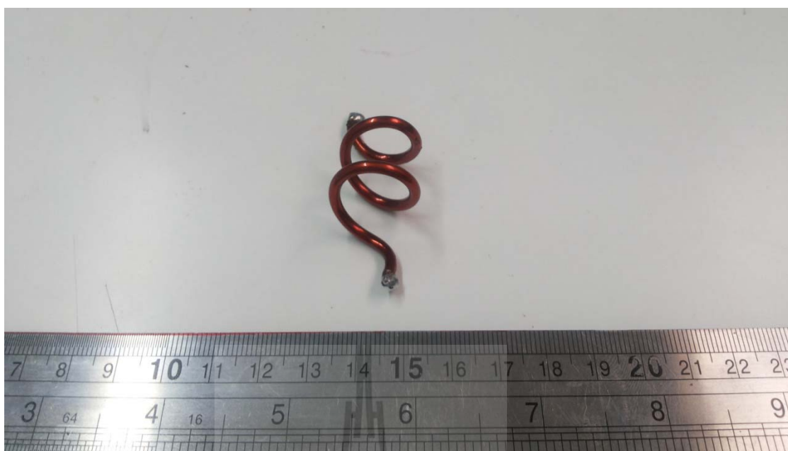
รูปที่ 4.6 คุณลักษณะของขดลวดที่ออกแบบที่ออกแบบสำหรับเมตซิงกับโหลดไดอิเล็กตริก ที่มีขนาดความหนาเท่ากับ 10 มิลลิเมตร
