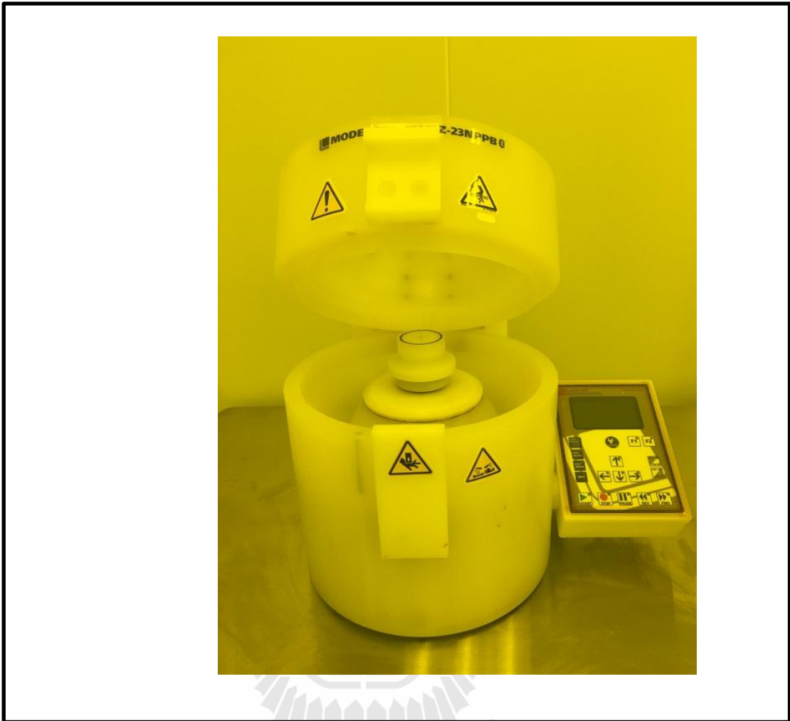
รูปที่ 3.8 เครื่องหมุนเคลือบสารไวแสง (Spinner)
