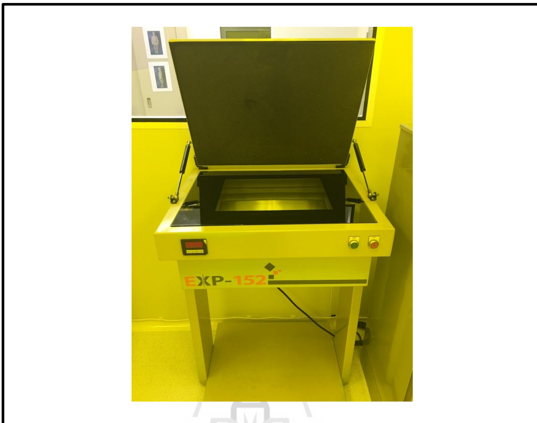
รูปที่ 3.21 เครื่องฉายแสงแผ่นวงจรมิพด้วยหลอดอัลตราไวโอเลต
