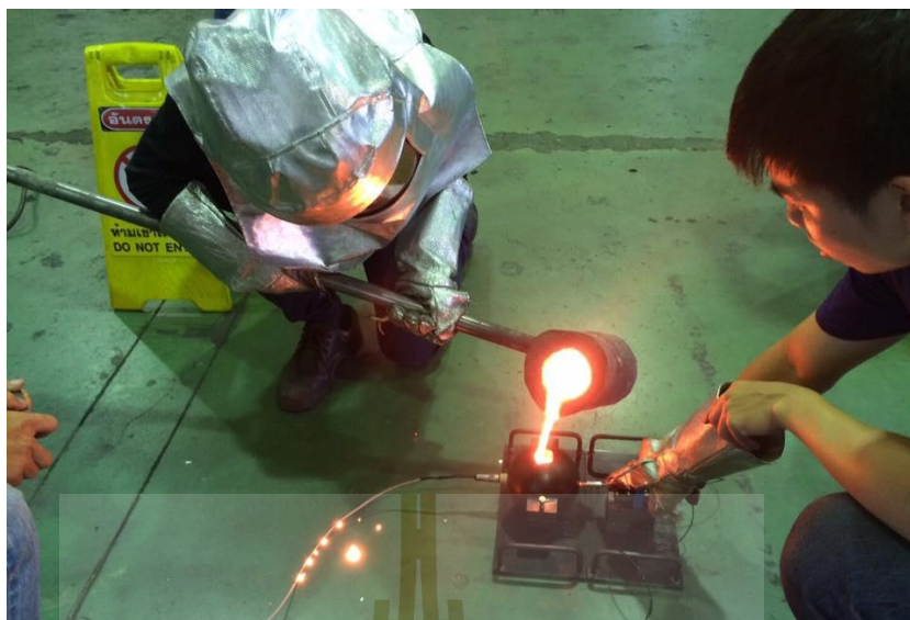
รูปที่ 3.20 การเทน้ำโลหะลงชิ้นงานวิจัย
