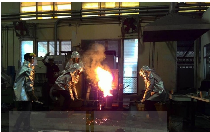
รูปที่ 3.18 การทำแมกนีเซียมทรีทเมนต์ โดยวิธี Sandwich method
