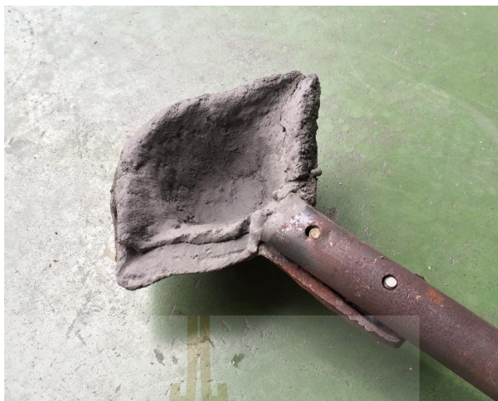
รูปที่ 3.5 เบ้ารองรับน้ำโลหะสำหรับชั่งตัวอย่าง
