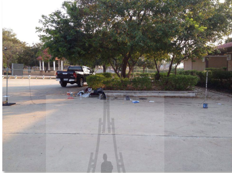
รูปที่ 4.10 วิธีวัดแบบรูประนาบสนามไฟฟ้าของสายอากาศต้นแบบ
