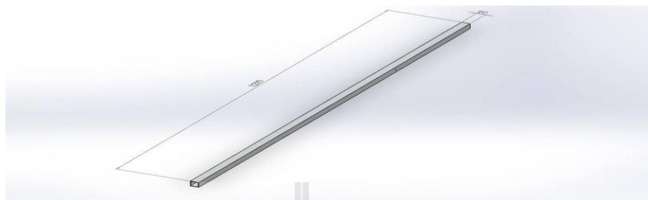
รูปที่ 3.39รูปแบบการตัดท่อกล่องอลูมิเนียม เส้นผ่านศูนย์กลาง 20 มิลลิเมตร ให้มีความยาวขนาด 1200มิลลิเมตร
