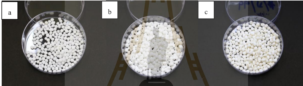
รูปที่ 5 แสดงลักษณะของการเคลือบเม็ดปุ๋ยโดยใช้สารเคลือบชนิดต่างๆ (a) เม็ดปุ๋ยยูเรียที่ยังไม่ผ่านการเคลือบ, (b) ปุ๋ยยูเรียเคลือบไฮดรอกซีอะพาไทท์และ (c) ปุ๋ยยูเรียเคลือบไฮดรอกซีอะพาไทท์ผสม PLA
