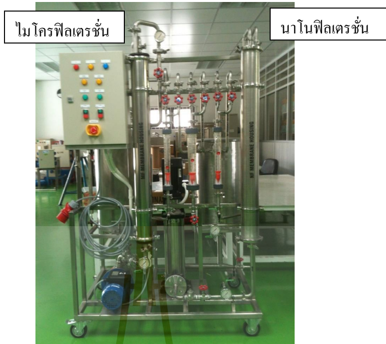
รูปภาพ 13 ระบบไมโครฟิลเตรชันและนาโนฟิลเตรชันสำหรับการแยกเซลล์แบคทีเรียและโปรตีนที่ใช้ในโครงการวิจัยนี้
