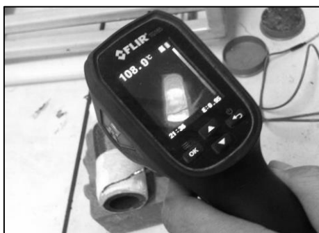
รูปที่ 4.3 อุณหภูมิของแท่งเหล็กหลังป้อนแรงดันไฟฟ้ากระแสสลับ 110 โวลต์ 5 นาที
