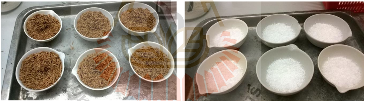
รูปภาพ 12 การเตรียมสารประกอบซิลิกอนจากเปลือกข้าว (ซ้าย) และ ขี้เถ้าแกลบที่ผ่านการเผาแล้ว (ขวา)
