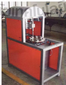
ภาพที่ 2.1 เครื่องคว้านเมล็ดลำไยโดยใช้การจำลองพฤติกรรมเชิงกล
