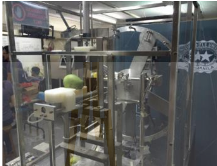
ภาพที่ 2.4 เครื่องต้นแบบสำหรับปกเปลือกมะม่วง
