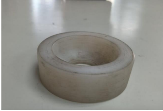
ภาพที่ 4.1 แสดงลักษณะแท่นวางผลเงาะสำหรับกลไกป้อนผลเงาะ
