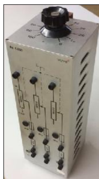
รูปที่ 6.12 โหลดตัวต้านทานสำหรับชุดทดสอบ
