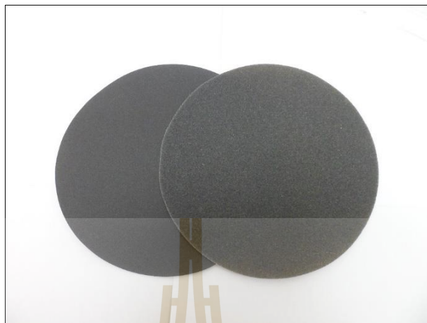
รูปที่ 3.6 กระดาษทรายที่ใช้ในการวิจัย
