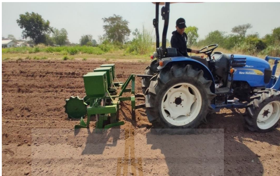
รูปที่ ข.3 การทำงานของเครื่องปลูกข้าวในแปลงทดสอบ 2
