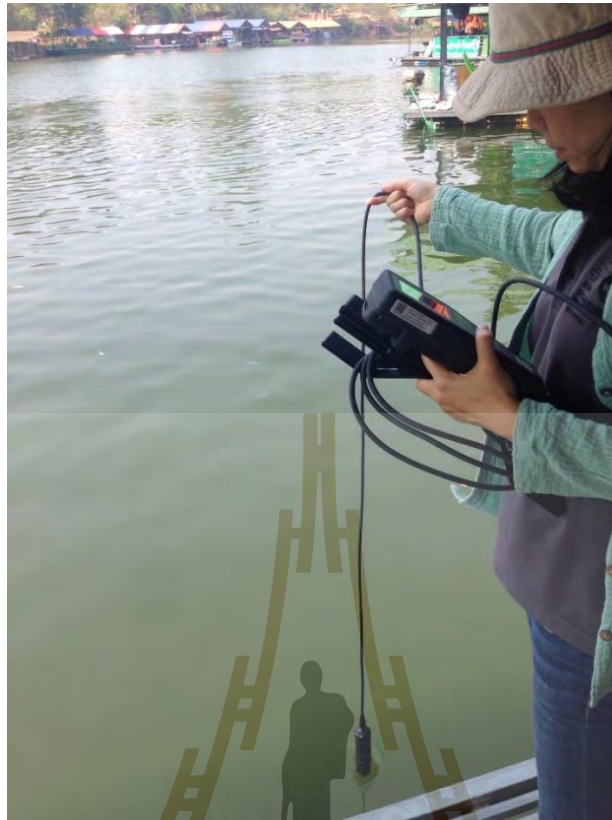
รูปที่ จ-1 การวิเคราะห์ค่าออกซิเจนละลายภาคสนามด้วยเครื่อง Multi probe meter
