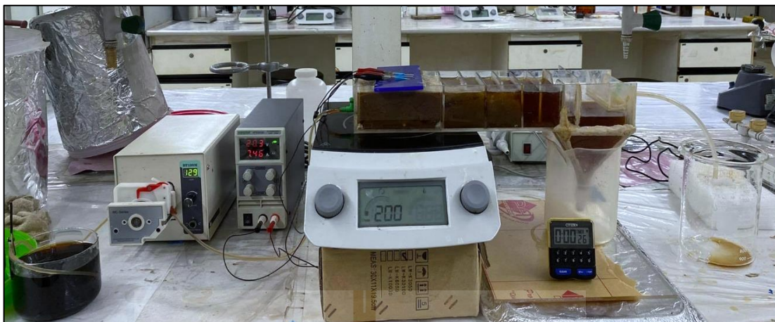
รูปที่ 4.21 ชุดการทดลองระบบ EC แบบ continuous ระบบ C3 (ระบบจริง)
