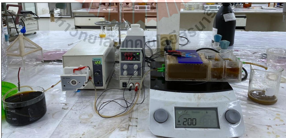
รูปที่ 4.13 ชุดการทดลองระบบ EC แบบ continuous ระบบ C1 (ระบบจริง)
