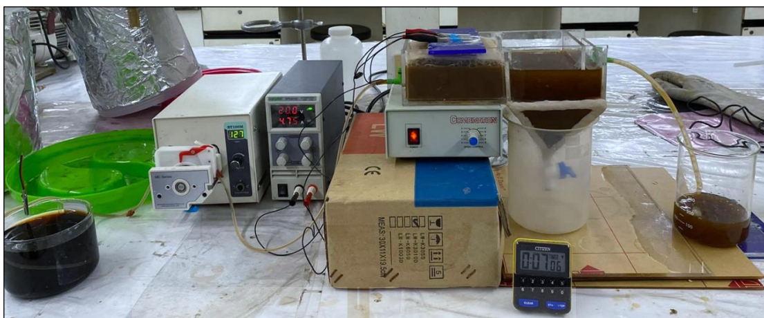
รูปที่ 4.17 ชุดการทดลองระบบ EC แบบ continuous ระบบ C2 (ระบบจริง)
