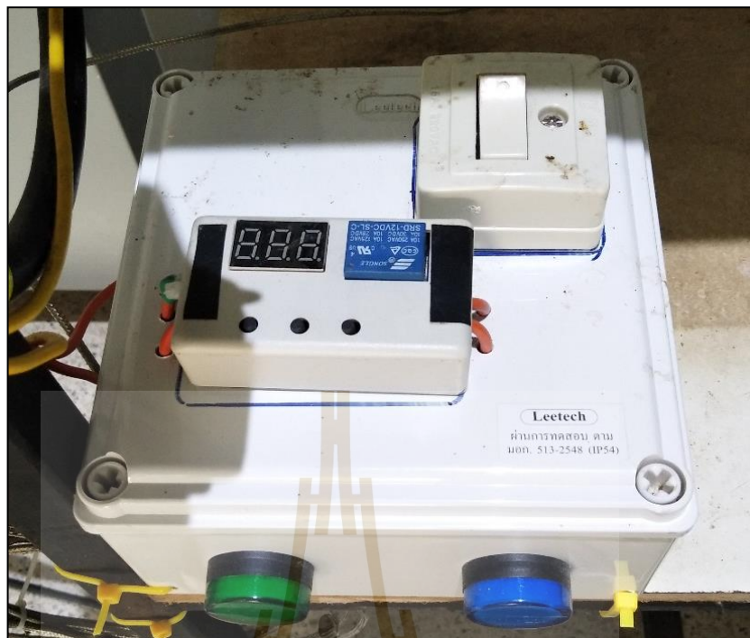
รูปที่ 4.15 ชุดควบคุมเวลา (Timer Relay) แบบปรับตั้งค่าได้ ช่วงเวลาปรับค่าได้ตั้งแต่ 0.1 s ถึง 999 min
