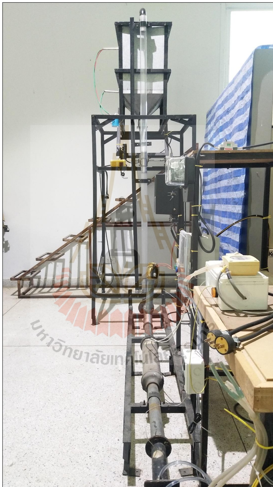
รูปที่ 4.3 ด้านข้างของเครื่องอบแห้งข้าวเปลือกแบบพาหะลมในท่อแนวตั้งต้นแบบที่ใช้ในงานวิจัย
