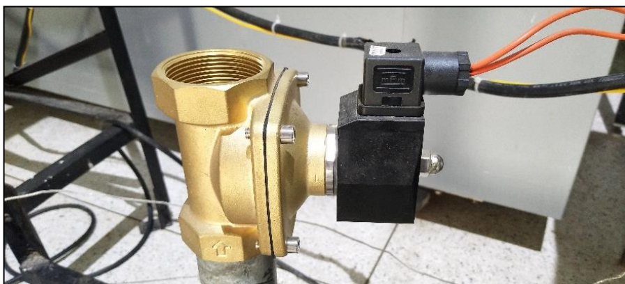
รูปที่ 4.14 โซลินอยด์วาล์วทองเหลือง ของ Power Tech รุ่น 2W - 400 - 40 ขนาด 1.5 in
