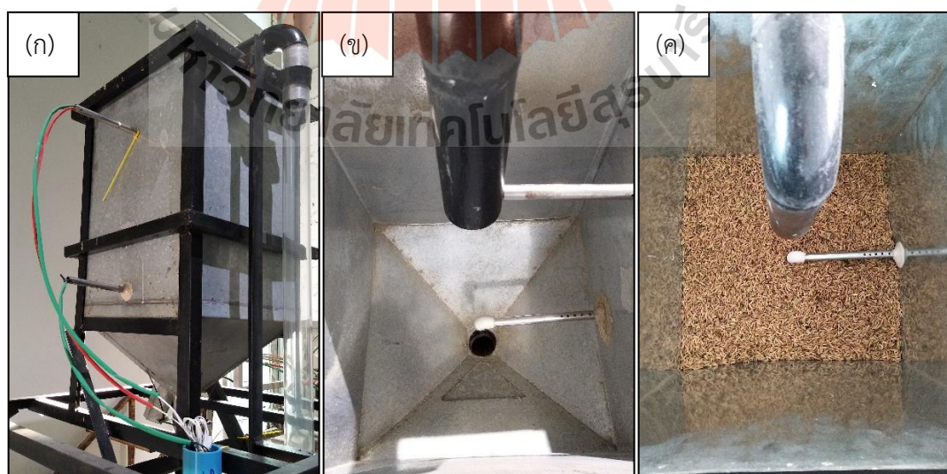
รูปที่ 4.11 (ก) แสดงรูปทรงสี่เหลี่ยมภายนอกของถังพักข้าวเปลือก (Paddy container) ที่ทำจากแผ่นเหล็กอบสังกะสี (ข) และ (ค) แสดงตำแหน่งติดตั้งอุปกรณ์วัดอุณหภูมิเมล็ดข้าวเปลือกภายในถังพัก
