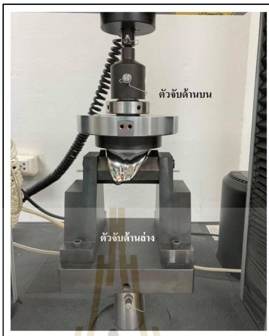
รูปที่ 3.12 การตั้งค่าทดลองประเมินการสัมผัสทางกลโดยใช้เทคนิคฟิล์มฟูจิ
