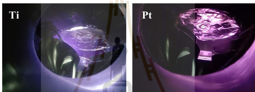
รูปที่ 3.11 สีของพลาสมาขณะเกิดการตกสะสมเคลือบด้วยกระบวนการดีซีแมกนีตรอนสปัตเตอริง
