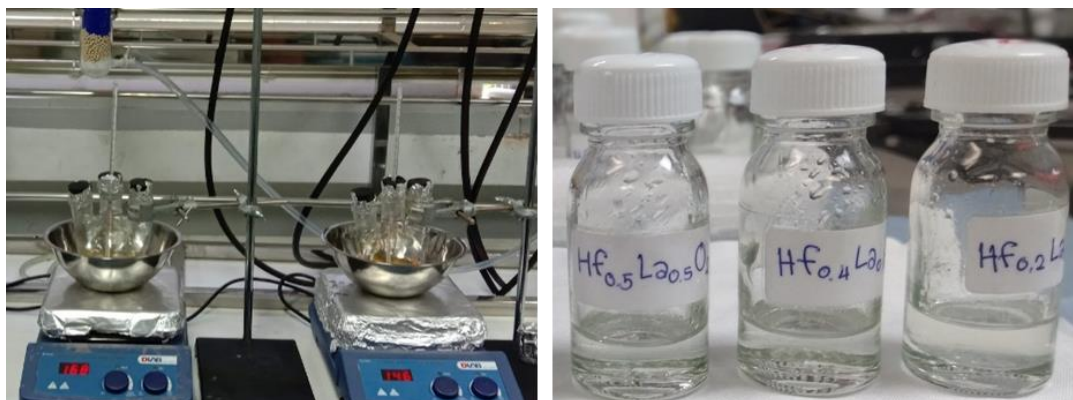
รูปที่ 3.4 เจลฮาฟเนียมออกไซด์ที่เจือด้วยแลนทานัมจากการสังเคราะห์ด้วยวิธีโซล-เจล
