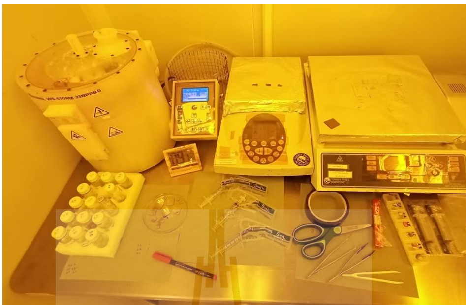
รูปที่ 3.12 ชุดอุปกรณ์ที่ใช้ในการเคลือบฟิล์มบางฮาฟเนียมออกไซด์ที่เจือด้วยแลนทานัมด้วย กระบวนการหมุนปั่นเคลือบ
