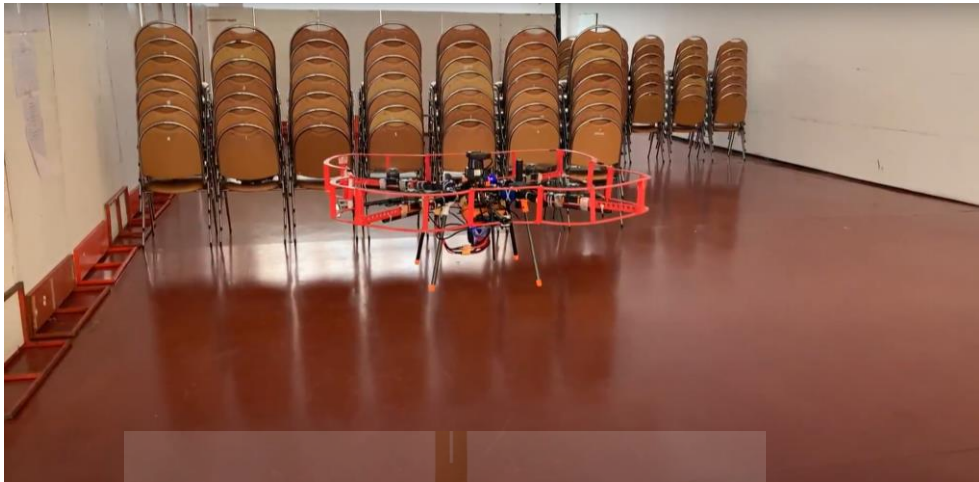
รูปที่ 3.12 การทดสอบระบบการบินอัตโนมัติภายในอาคารกรณีมีสิ่งกีดขวาง ( https://youtu.be/ELT4e9B1iLI )
