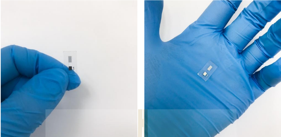
ภาพที่ 4.99 ภาพถ่าย silver microband electrode arrays ขนาด r = 20 \mu\text{m} , d = 20 \mu\text{m}
