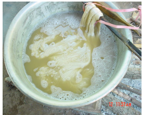
รูปที่ 2.16 ขั้นตอนการล้างเส้นไหม
