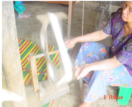
รูปที่ 2.2 ขั้นตอนการปั่นเส้นใย
