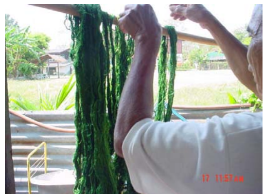
รูปที่ 2.22 การตากเส้นไหมที่ผ่านการย้อมแล้ว
