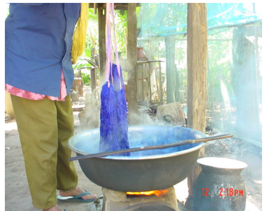
รูปที่ 2.18 ขั้นตอนในการข้อมสีผ้า
