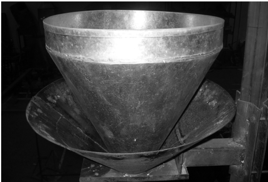
รูปที่ 4.8 ถังพักข้าวเปลือกด้านบน
