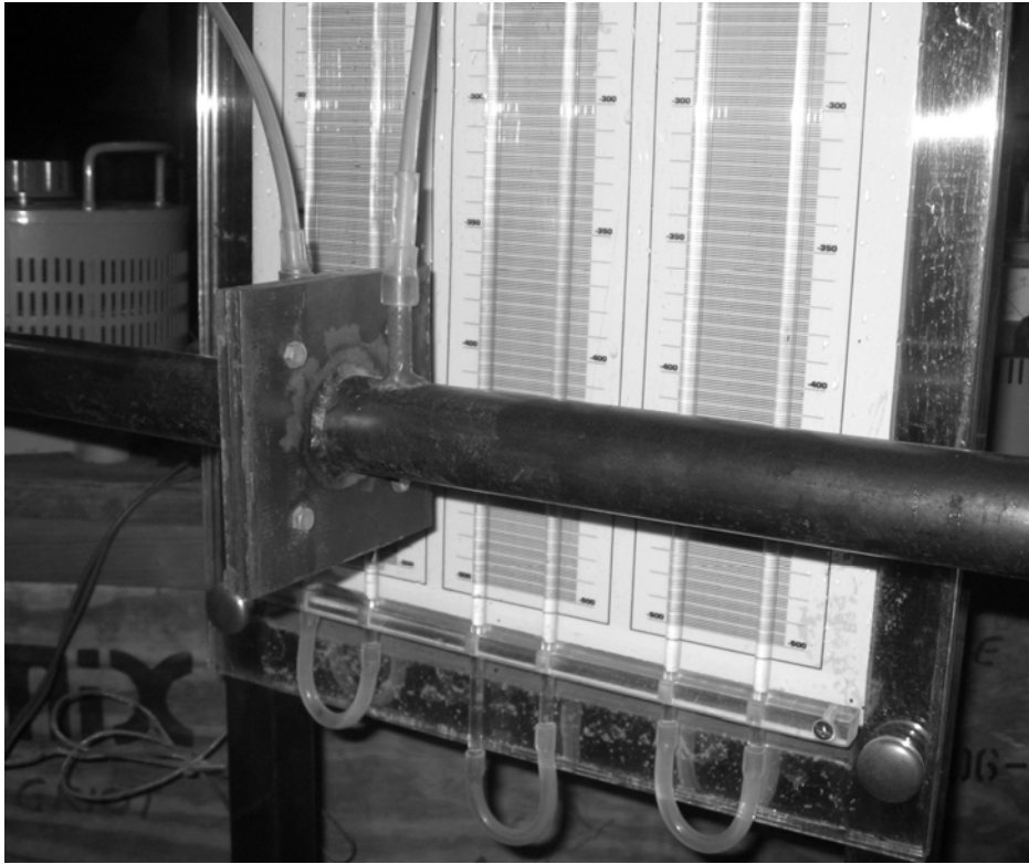
รูปที่ 4.5 Orifice plate และ U-tube manometer ที่ใช้ในงานวิจัย
