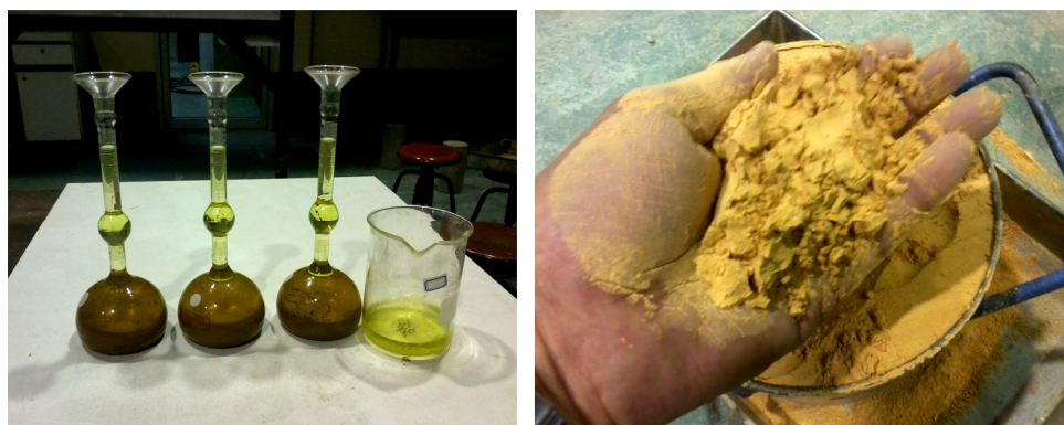
รูปที่ 3.8 การทดสอบหาค่าความถ่วงจำเพาะและหน่วยน้ำหนักของวัสดุประสาน
