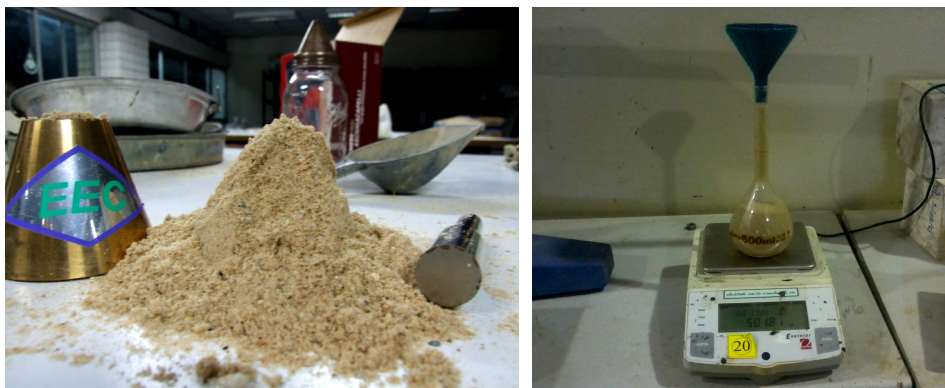
รูปที่ 3.6 การทดสอบหาค่าความถ่วงจำเพาะและค่าการดูดซึมน้ำของทราย
