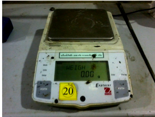
รูปที่ 3.10 เครื่องชั่งสำหรับหาหน่วยน้ำหนัก ซึ่งได้ละเอียด 0.01 กรัม
