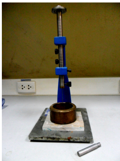
รูปที่ 3.12 ชุดทดสอบแบบไวเคต (Vicat apparatus)
