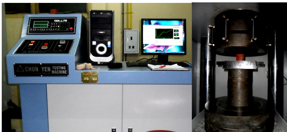
รูปที่ 3.13 เครื่องทดสอบกำลังอัด (Compressive machine 500 Tons)
