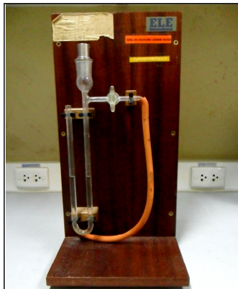
รูปที่ 3.9 ชุดทดสอบหาความละเอียดของวัสดุประสาน ด้วยวิธีของเบลน (Blaine finness)
