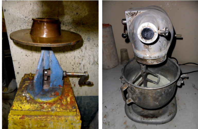
รูปที่ 3.11 ชุดทดสอบการไหลแผ่
