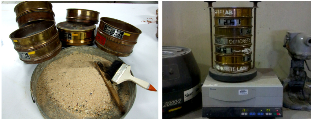
รูปที่ 3.7 การทดสอบหาขนาดคละและ โมคูลัสความละเอียดของทราย
