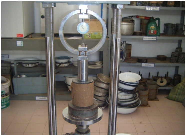
รูปที่ 3.5 การทดสอบกำลังรับแรงอัด
