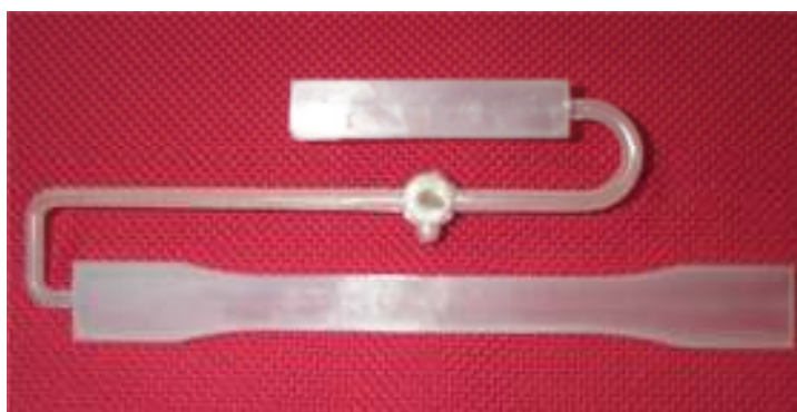
รูปที่ 2.1 ชิ้นทดสอบการต้านทานแรงดึง และ ความต้านทานการกระแทก
