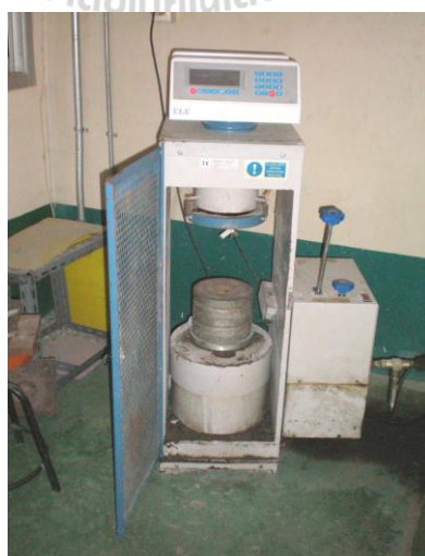
รูปที่ 3.8 แสดงเครื่องอัดแบบไฮดรอลิกแรงอัดขนาด 200 ตัน
