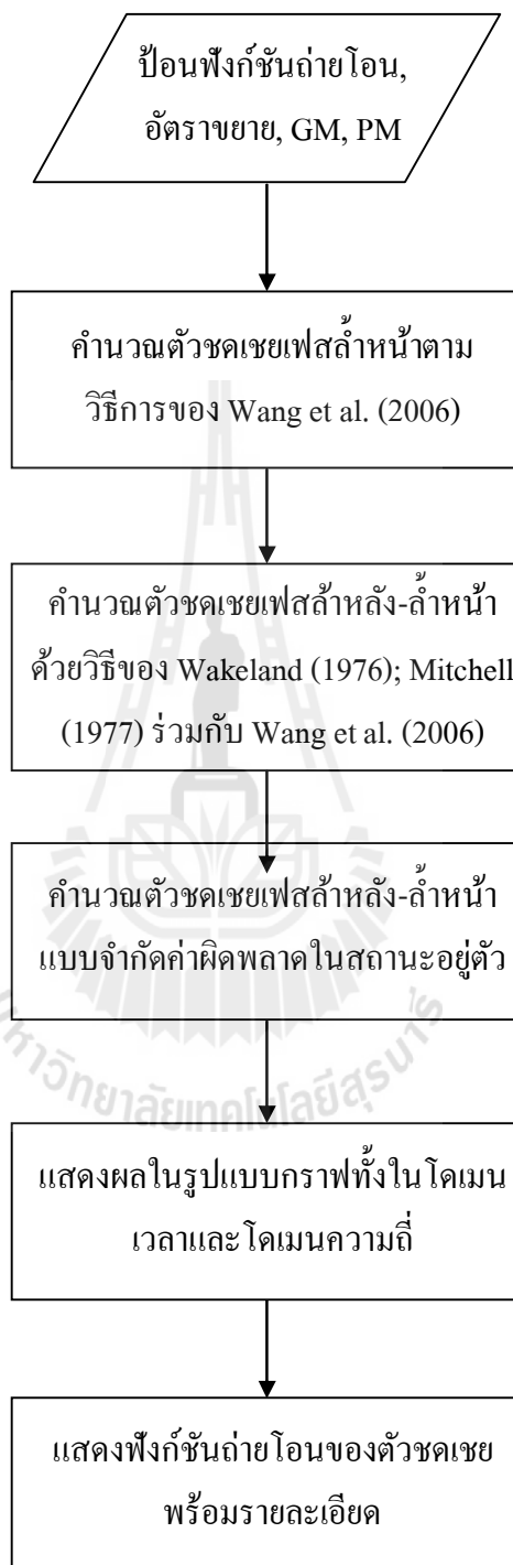
รูปที่ 5.1 โครงสร้างการทำงานของโปรแกรมที่ใช้ในการออกแบบตัวชดเชย
